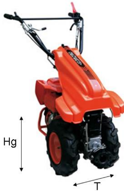
Figura 18: La trocha (T) y la altura del centro de gravedad (Hg) influyen en la posibilidad de vuelco del motocultor
