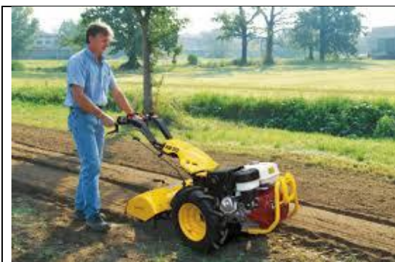
Figura 13: Operario con el manillar hacia el costado para caminar sobre el suelo no laboreado
