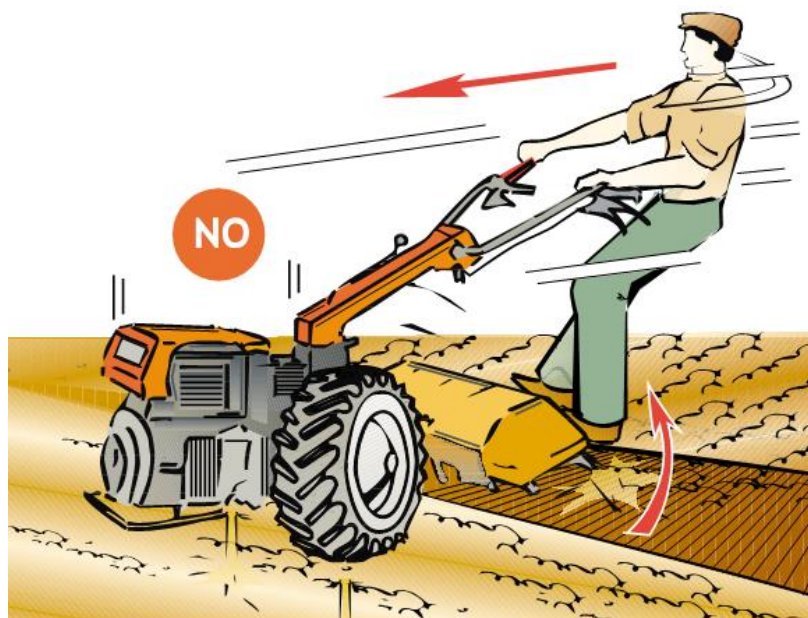
Figura 16: Cuando las azadas topan con algo duro NO pararse sobre la carcasa ni acelerar. Reducir la velocidad y mantener firmemente sujeta la manquera (sin presionarla contra el piso)
