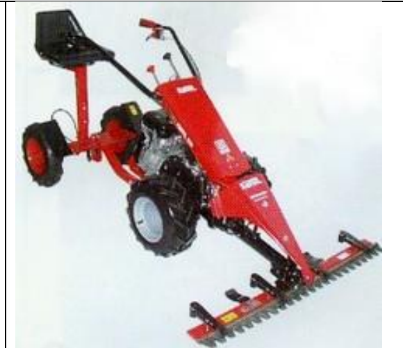
Figura 10: Con barra guadañadora
