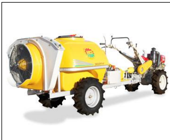
Figura 11: Con pulverizador hidroneumático
