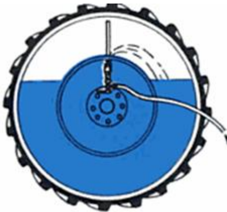
Figura 117: Las ruedas de los tractores se pueden llenar con agua para aumentar el peso estático (Izquierda). Los tractores traen un conjunto de lastres metálicos que se abulonon a los discos de las ruedas del eje trasero (Derecha)
