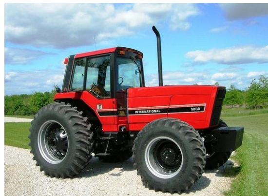
Figura 115: Tractores FWA con dos ejes motrices, el delantero con neumáticos de menor tamaño y responsabilidad en la tracción. Distribución de peso estática: 60% eje trasero; 40% eje delantero. Con la transferencia de peso pasaría a tener una distribución de 70% atrás y 30% adelante. Estos tractores tienen “avance cinemático” y para facilitar el patinamiento del eje delantero es conveniente aumentar la transferencia de peso alargando y elevando la barra de tiro
