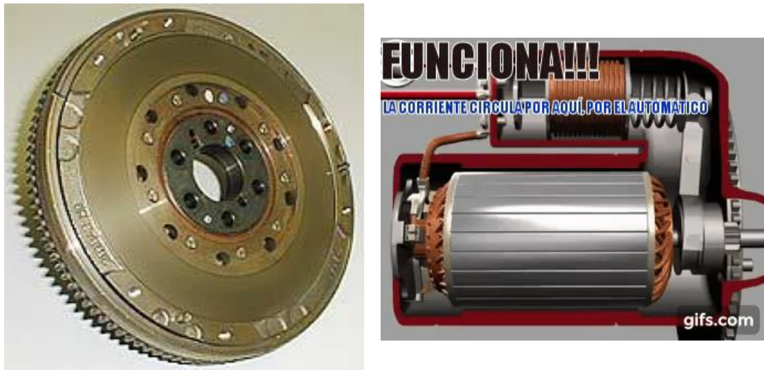
Figura 10: Izquierda: Volante de inercia con corona exterior, al mismo se acopla el embrague. Derecha: Motor de arranque actuando sobre la corona exterior del volante durante el encendido
