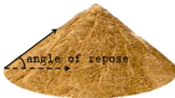
Figura 245: Talud de un suelo arenoso. El ángulo que forma la pila es el ángulo de roce interno \phi
