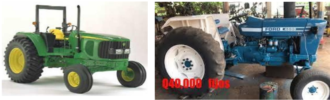
Figura 177: Tractor con chasis (Izquierda) Tractor sin chasis o monoblock (Derecha)
