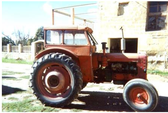
Figura 109: Tractores con cabina (Izquierda) y techo (Derecha) que no protegen del vuelco
