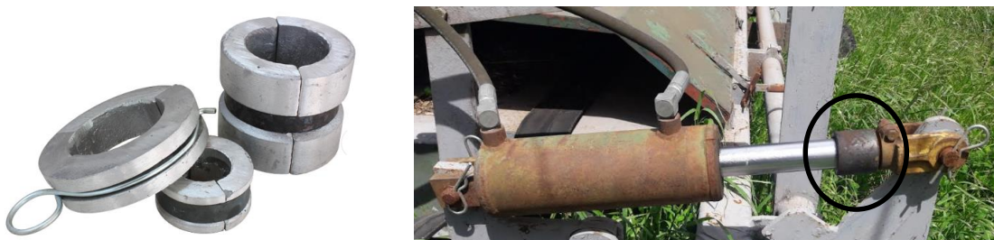
Figura 210: Topes para limitar el recorrido de los cilindros hidráulicos (Izquierda) Torno que limita el recorrido del cilindro hidráulico (Derecha) Ambos elementos son usados para controlar la profundidad en cilindros de control remoto
