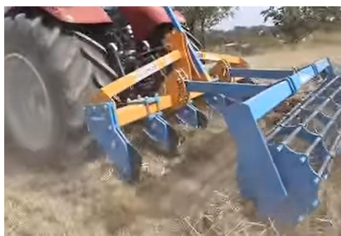
Figura 232: Equipos montados que se trabajan en control de carga. Descompactador con rolo (Izquierda) Arado de reja y vertedera reversible (Derecha)
