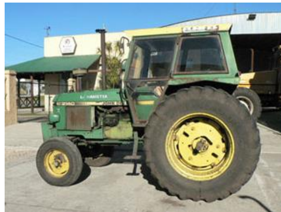
Figura 114: Tractores 2WD. Un solo eje motriz trasero. Eje delantero directriz. Distribución de peso estática: 2/3 eje trasero; 1/3 eje delantero. Con la transferencia de peso podría llegar a tener una distribución ideal de 85% atrás y 15% adelante
