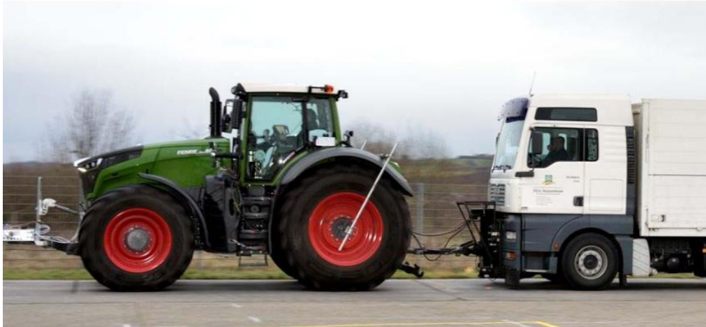
Figura 261: Camión dinamométrico utilizado para la prueba de tracción (OCDE, 2019)
