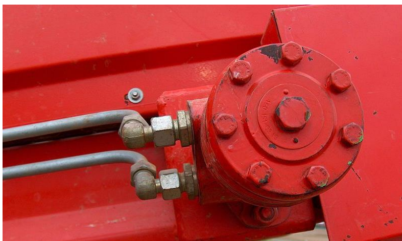
Figura 173: Motor de pistones radiales que gobierna el avance/retroceso de una pulverizadora autopropulsada. Se aprecian las dos vías por las que ingresa y sale el aceite
