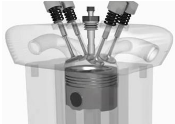
Figura 5: Ubicación de dos válvulas de admisión y dos de escape sobre la culata. En la parte central se encuentra el inyector.
