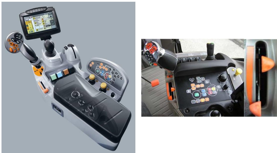
Figura 176: Mandos de una transmisión CVT. A la derecha pueden verse dos correderas. Con una de ellas se modifica la relación de transmisión de manera continua, la otra corresponde al acelerador de mano
