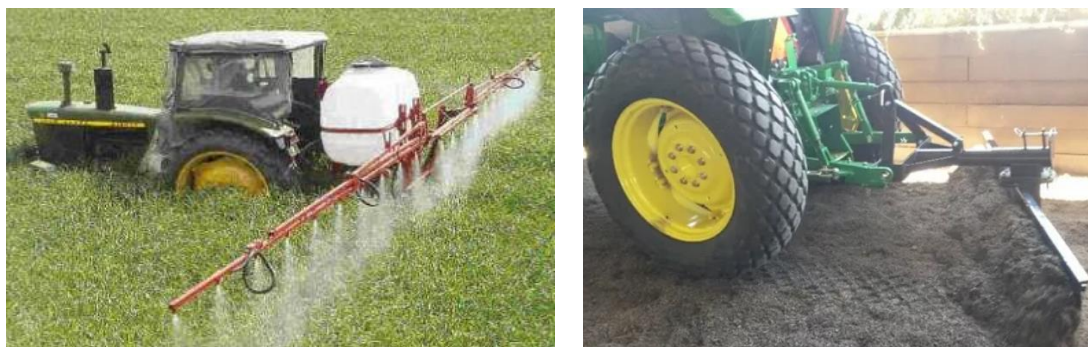
Figura 233: Aperos que se trabajan en Control de Posición. Pulverizadora montada (Izquierda) Hoja niveladora montada (Derecha)
