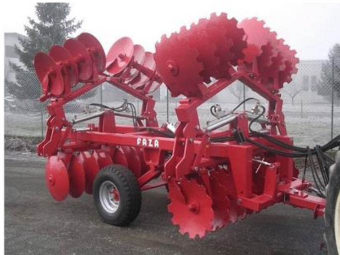
Figura 201: Rastra de discos doble acción. Se observan los 4 cilindros de control remoto que cambian de posición de transporte a trabajo (y viceversa) los cuerpos externos de la rastra. En la parte central se observa un cilindro que operando sobre las ruedas permitirá clavar y desclavar el implemento
