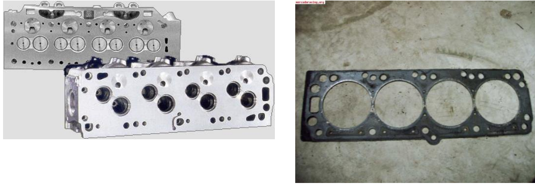
Figura 4: Tapas de cilindros (Izquierda) y junta de tapa de cilindros (Derecha)
