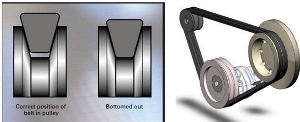
Figura 120: Transmisiones por correa trapezoidal. A la Izquierda se muestra la posición correcta de la correa en la polea, y a la Derecha un tren de dos poleas en paralelo
