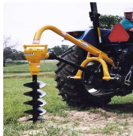
Figura 167: Rotoenfardadora accionada por TPP (Izquierda) Hoyadora montada accionada por la TPP (Derecha)
