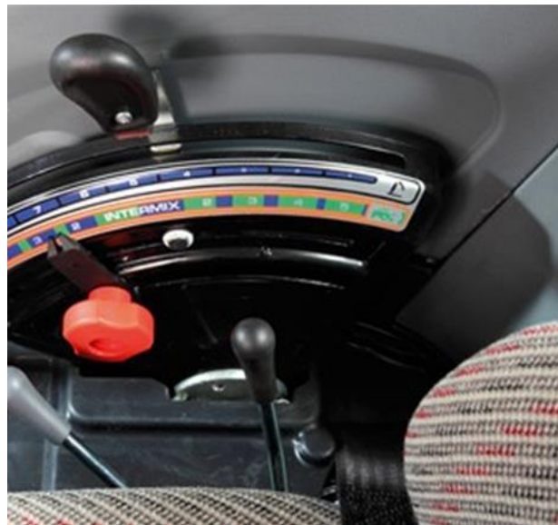
Figura 226: Palanca de elevación descenso del elevador de tres puntos. Se aprecia el indicador que guía al tractorista para clavar el implemento siempre a la misma profundidad
