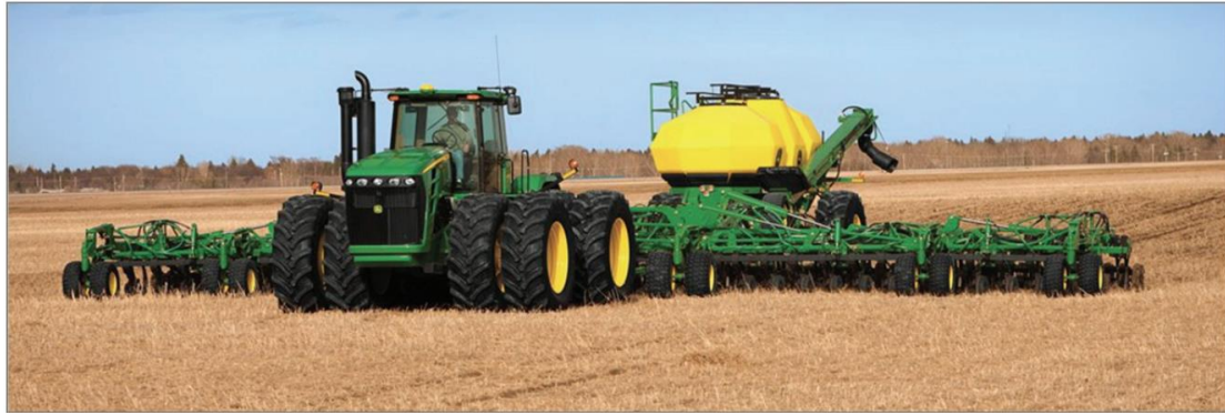
Figura 195: Sembradora para sistemas convencionales (con labranza) arrastrada por tractor convencional (Arriba) Sembradora para siembra directa tipo Air Drill arrastrada por tractor articulado con duales (Abajo)
