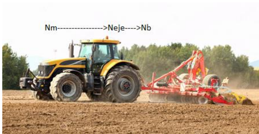
Figura 238: La potencia que sale del motor llega al eje de las ruedas a través de las transmisiones con una pérdida fija. Entre el eje de las ruedas y la barra de tiro están las pérdidas variables de patinamiento y rodadura
