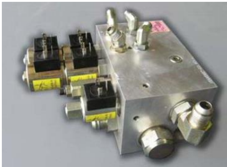
Figura 220: Electroválvulas. A la izquierda de la imagen se observan los conectores eléctricos que tiene adosados la válvula. A la derecha se observan terminales de caños que dirigirán el aceite para uno u otro lugar en función de las órdenes que se emitan desde botones, Joysticks, etc.
