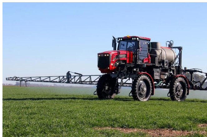
Figura 99: Las pulverizadoras autopropulsadas o “mosquitos” presentan el centro de gravedad muy elevado lo que las vuelve inestables
