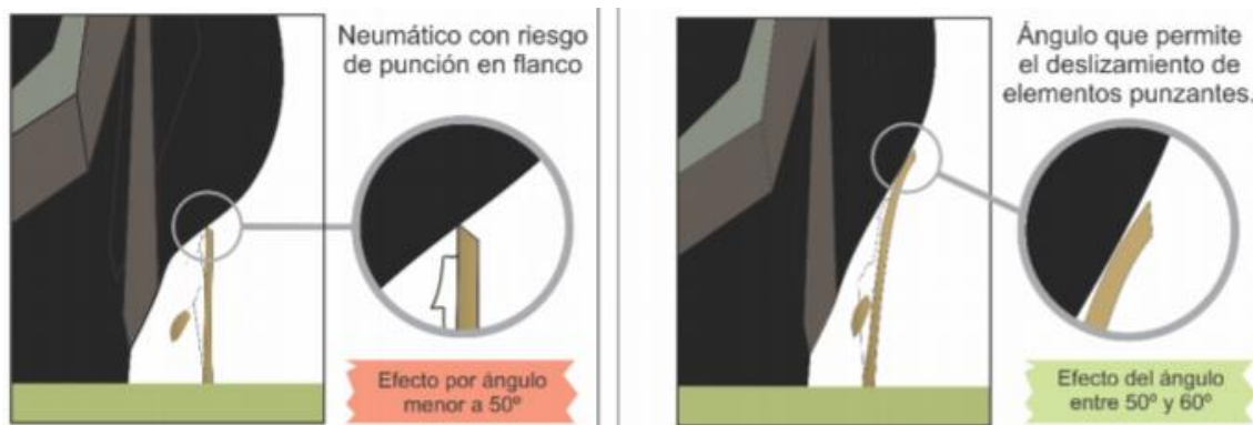
Figura 253: La deflexión y menor resistencia de los flancos de los neumáticos radiales los hace más susceptibles de recibir daños en estas ubicaciones. Una presión de inflado deficiente aumenta la posibilidad de que los mismos se dañen con elementos punzantes (INTA, Ferrari et al., 2016)
