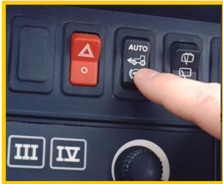
Figura 182: En los tractores FWA la tracción delantera se conecta y desconecta desde la cabina (Izquierda) El lastre delantero imposibilita que el eje delantero patine, solo con equipos montados se debería agregar lastre adelante (Derecha)
