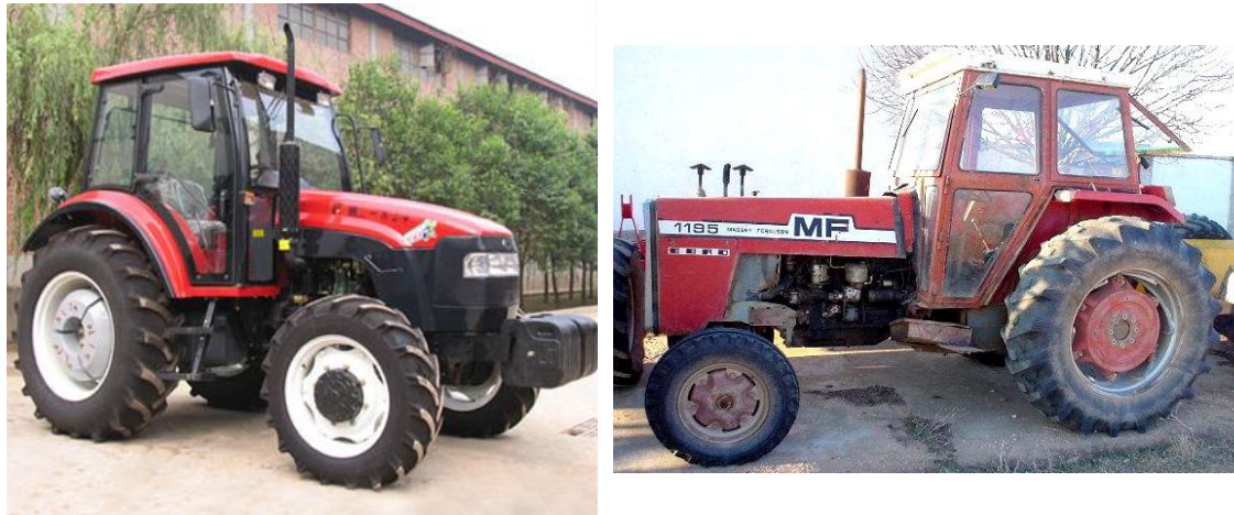
Figura 97: Tractor de batalla chica, 2,2m (Izquierda) y tractor de gran batalla, 2,65m (Derecha)
