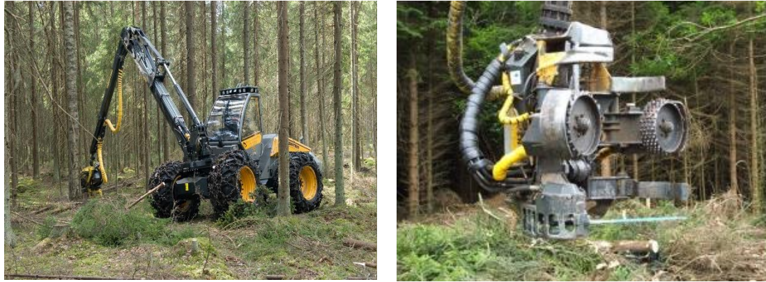
Figura 198: Izquierda: Harvester, tractor especial para cosechar árboles Derecha: Detalle del cabezal
