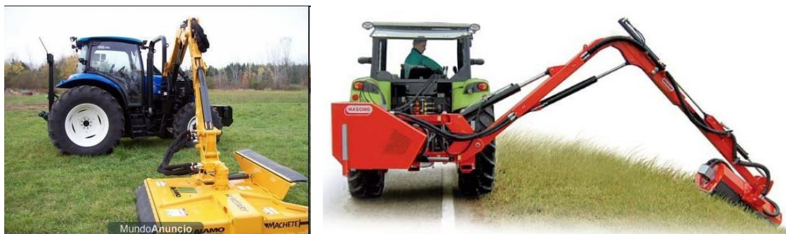
Figura 196: Tractores llevando segadoras. Se aprecian los cilindros que permiten alargar o acortar la distancia hacia el cabezal de corte, subirlo y bajarlo, inclinarlo y las mangueras que llegan al mismo para accionar el motor hidráulico que hace girar las cuchillas de corte. Se puede apreciar la dificultad que implicaría llegar hasta ese lugar con movimiento rotacional a través de barras cardánicas
