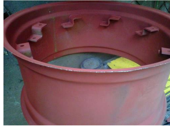
Figura 159: Posibilidad de variación de trocha por concavidad del disco (Izquierda) y excentricidad de fijación en la llanta con dos posibles puntos de fijación (Derecha)
