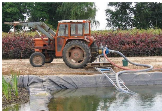
Figura 165: TPP accionando una bomba de riego (Izquierda) y una chipeadora (Derecha)
