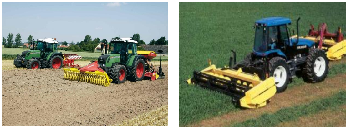
Figura 200: Tractores con equipos montados. Arado de reja y vertedera, rolo desterronador y sembradora (Izquierda) Segadoras de forraje (Derecha)
