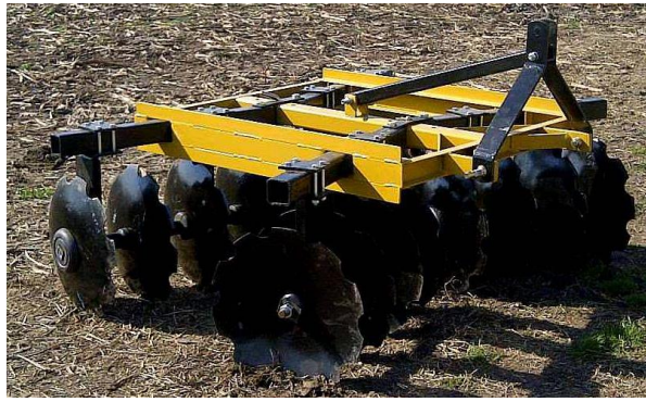
Figura 231: Implementos montados que se trabajan en flotante porque tienen sus propias ruedas o patines para copiar el relieve. Rastra de discos (Izquierda) Arado rotativo, fresadora o Rotovactor (Derecha)
