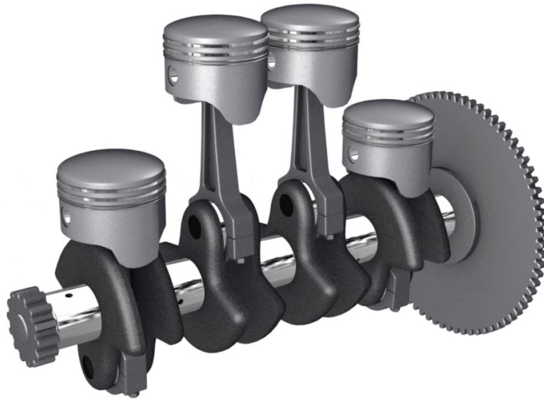
Figura 8: Pistones vinculados al cigüeñal mediante la biela. En uno de los extremos del cigüeñal se observa el volante de inercia (con una corona dentada donde actúa el motor de arranque) mientras que en el extremo opuesto un engranaje encargado de distribuir movimiento a los elementos accesorios del motor (bombas, árboles de levas, ventilador, etc.)
