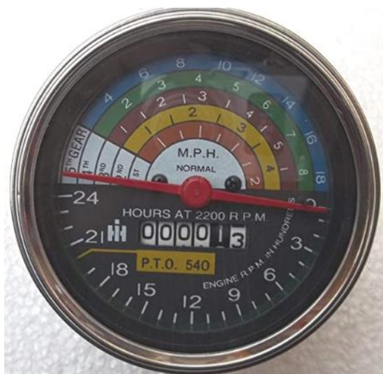
Figura 82: Tacómetro del tractor en el que se observa en la parte inferior la indicación de vueltas del motor (en cientos) y cercano a 21 se encuentra el valor en el que se debe ubicar la aguja para obtener las 540rpm en la TPP (o PTO en el tacómetro). Sobre la parte superior se observan en distintos colores las velocidades alcanzadas en función del régimen en las distintas marchas. En la parte central, un contador de horas (no de km) para poder hacer seguimiento de las tareas de mantenimiento.
