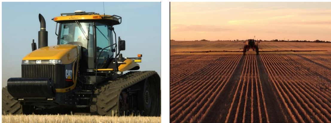
Figura 235: Tractor Caterpillar de 20,3 toneladas, 400CV y bandas de oruga para aumentar la capacidad tractiva (Izquierda) Para reducir el efecto del tránsito se ha propuesto el “tráfico controlado”, donde se produce no se transita, donde se transita no se siembra (Derecha)
