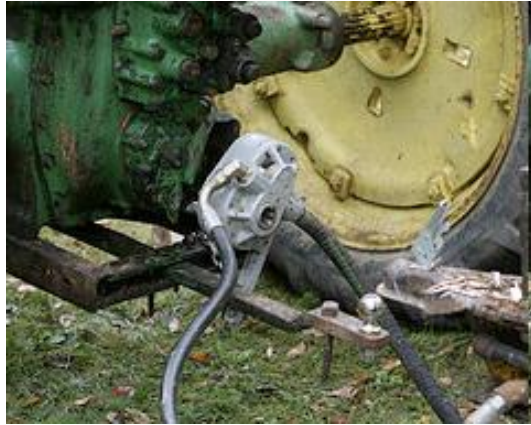
Figura 166: TPP accionando un motor hidráulico (Izquierda) Grupo electrógeno que demanda potencia rotacional a través de una barra cardánica (Derecha)
