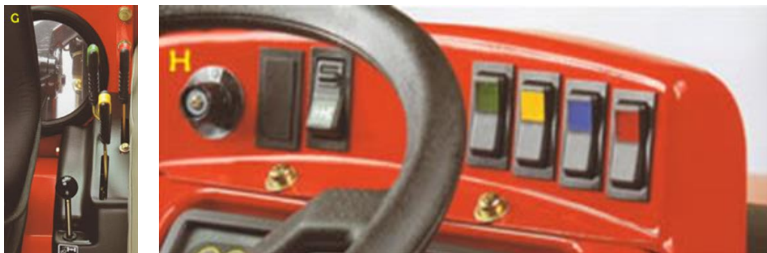
Figura 212: Mandos del sistema hidráulico. Palancas (Izquierda) Teclas (Derecha)
