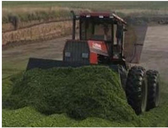
Figura 102: Situación de vuelco generada en la compactación de silos (Izquierda) Recomendación de maniobra para reducir el riesgo de vuelco ante pendiente excesiva anteroposterior (Derecha)
