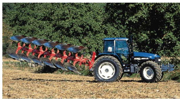
Figura 232: Equipos montados que se trabajan en control de carga. Descompactador con rolo (Izquierda) Arado de reja y vertedera reversible (Derecha)
