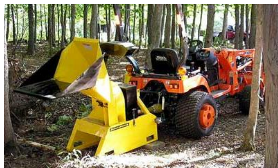
Figura 165: TPP accionando una bomba de riego (Izquierda) y una chipeadora (Derecha)
