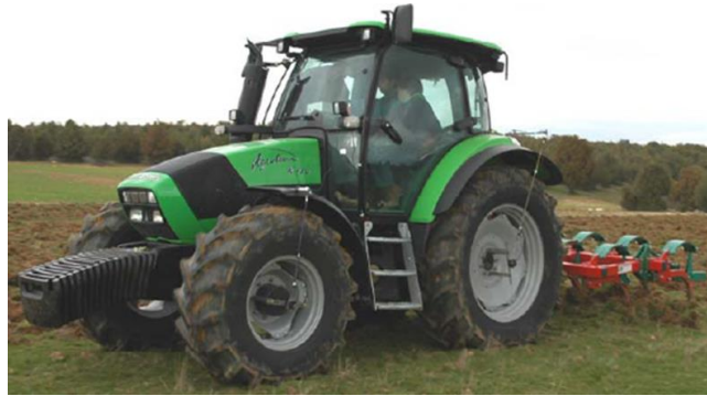
Figura 182: En los tractores FWA la tracción delantera se conecta y desconecta desde la cabina (Izquierda) El lastre delantero imposibilita que el eje delantero patine, solo con equipos montados se debería agregar lastre adelante (Derecha)
