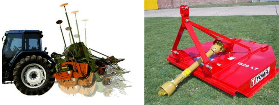
Figura 221: Sembradora montada (Izquierda) y Desmalezadora (Derecha). Ambos equipos apoyarán sus ruedas o patines en el suelo cuando estén trabajando por lo que la transferencia de peso que tendrán será inferior, de un 45% según Zoz
