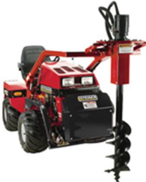
Figura 197: Hoyadora. Se aprecia en la parte superior del tornillo sinfín el motor hidráulico al que le llegan dos mangueras
