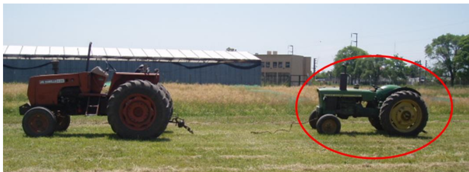
Figura 258: Determinación a campo de la resistencia al avance o Rodadura R . El tractor al cual se le determina R es el que va siendo arrastrado, en la figura se indica con un círculo rojo. Cerca de la barra de tiro del tractor de adelante se observa el dinamómetro que medirá la fuerza
