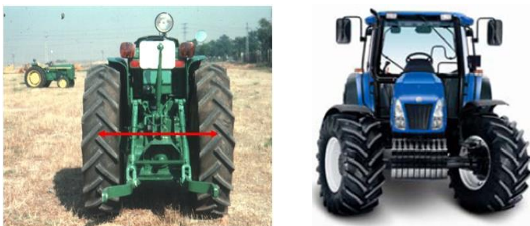
Figura 101: Tractor con trocha escasa (Izquierda) y con trocha importante (Derecha)
