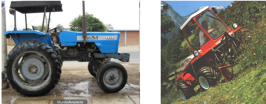
Figura 98: Tractor convencional con el centro de gravedad alto (Izquierda) y tractor especial con el centro de gravedad muy bajo apto para trabajar en laderas (Derecha)
