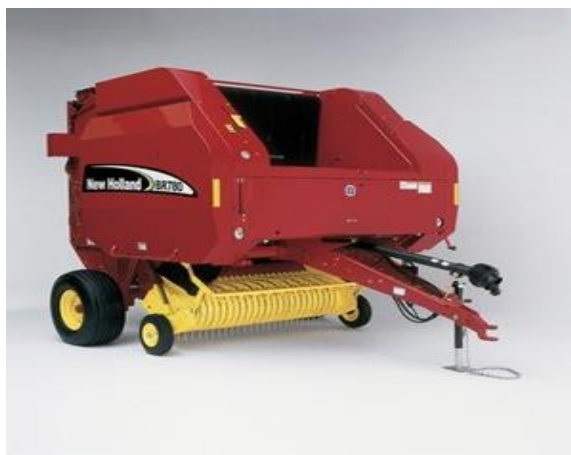
Figura 167: Rotoenfardadora accionada por TPP (Izquierda) Hoyadora montada accionada por la TPP (Derecha)
