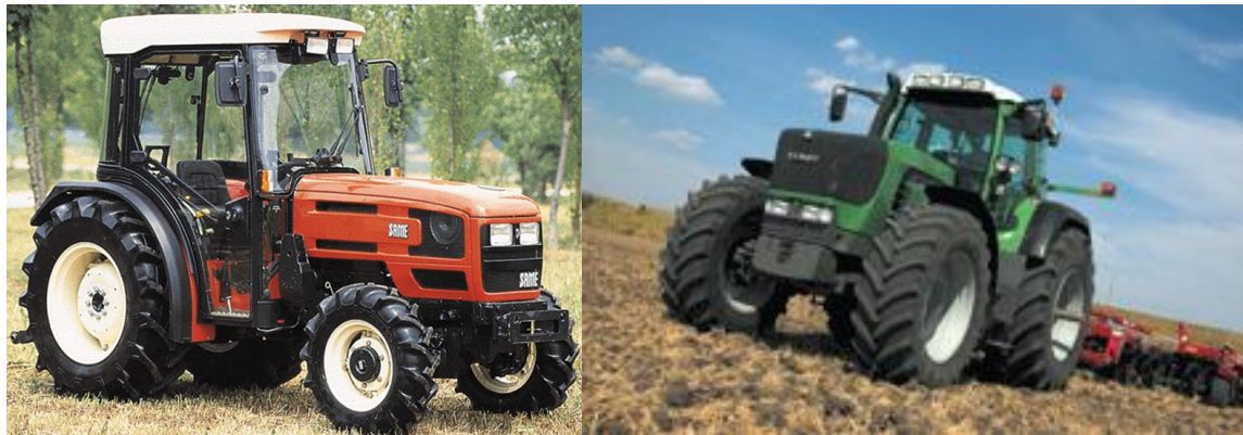
Figura 179: Tractores FWA. Izquierda: Ruedas delanteras muy pequeñas, el desempeño se parecerá al de un 2WD Derecha: ruedas delanteras similares a las traseras, el desempeño será semejante al de un 4WD
