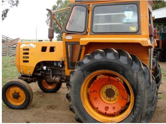
Figura 159: Posibilidad de variación de trocha por concavidad del disco (Izquierda) y excentricidad de fijación en la llanta con dos posibles puntos de fijación (Derecha)
