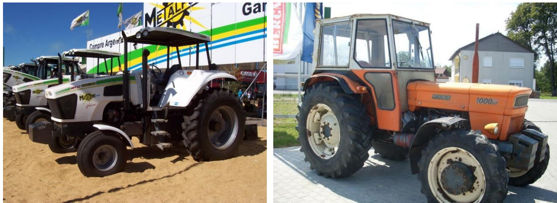
Figura 118: Lastres delanteros ubicados sobre el chasis en un tractor 2WD (Izquierda) y en un tractor FWA (Derecha). Estos lastres afirman el eje delantero buscando tener más dirección (en el 2WD) y más tracción y dirección (en el FWA) pero puede comprometer la capacidad de patinamiento de este último diseño
