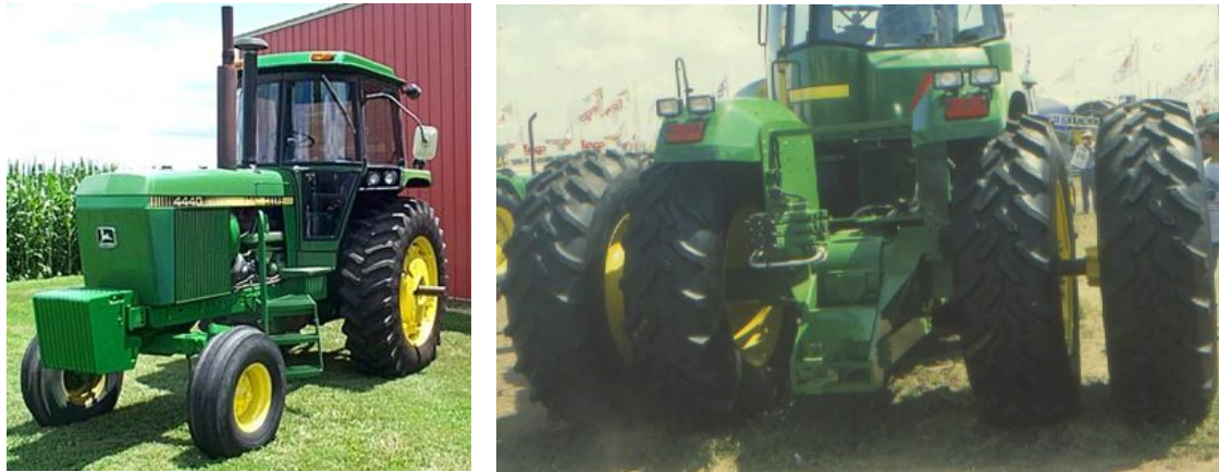
Figura 156: Mando final proximal. Izquierda: Se aprecia el palier libre que deja el mando final proximal en el eje trasero. Derecha: Cuando queda un palier libre la dual se acopla al mismo palier de la misma forma que la rueda interna pudiéndose lastrar
