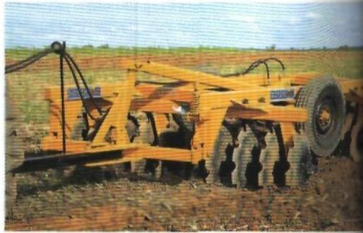
**Este implemento produce el arranque y volteo del material combustible.**
