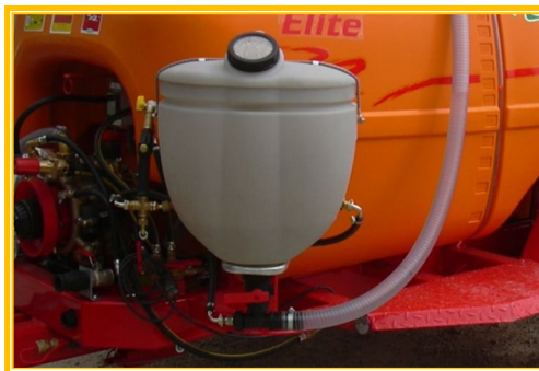
Fig. 22. Depósito de incorporación del producto fitosanitario.
