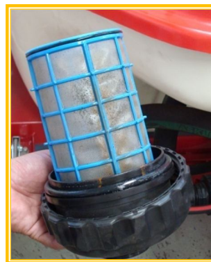
Fig.16. Filtro en buen estado y adecuado.
