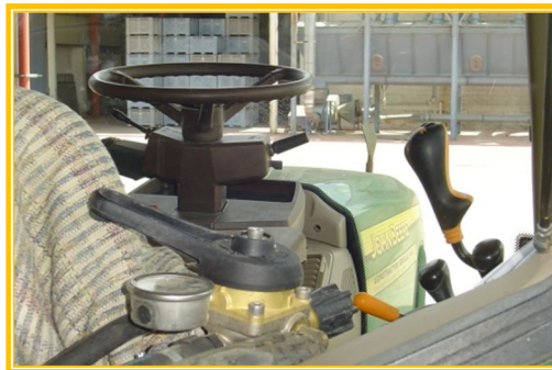
Fig. 13. Tubería dentro del puesto del conductor sin protección
