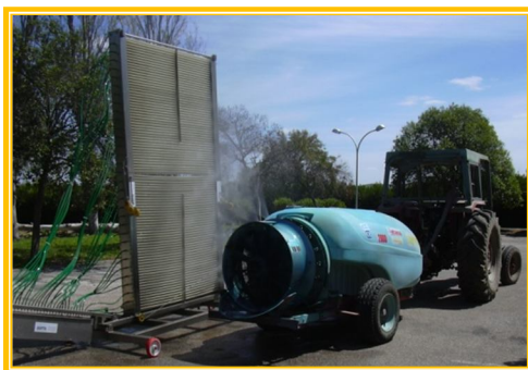
Fig. 29. Banco de distribución vertical.
