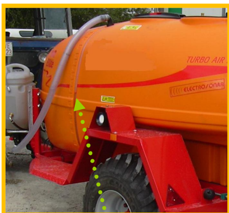
Fig. 8. Indicador de nivel visible desde el lugar de llenado.
