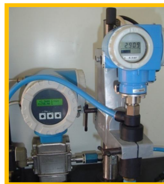
Fig. 30. Banco de ensayo de boquillas.
