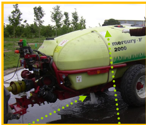
Fig. 10. Válvula de vaciado de la cuba con llave de apertura..
