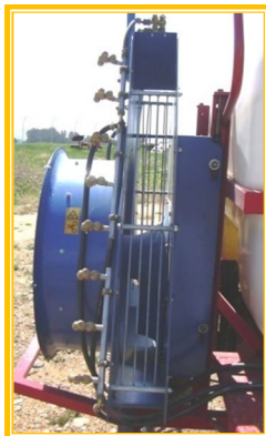
Fig. 20. Ventiladores con resguardos de protección en la zona de impulsión del aire (izquierda) y en la zona de aspiración (derecha).
