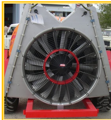
Fig. 20. Ventiladores con resguardos de protección en la zona de impulsión del aire (izquierda) y en la zona de aspiración (derecha).
