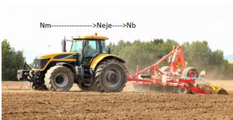
Figura 233: La potencia que sale del motor llega al eje de las ruedas a través de las transmisiones con una pérdida fija. Entre el eje de las ruedas y la barra de tiro están las pérdidas variables de patinamiento y rodadura
