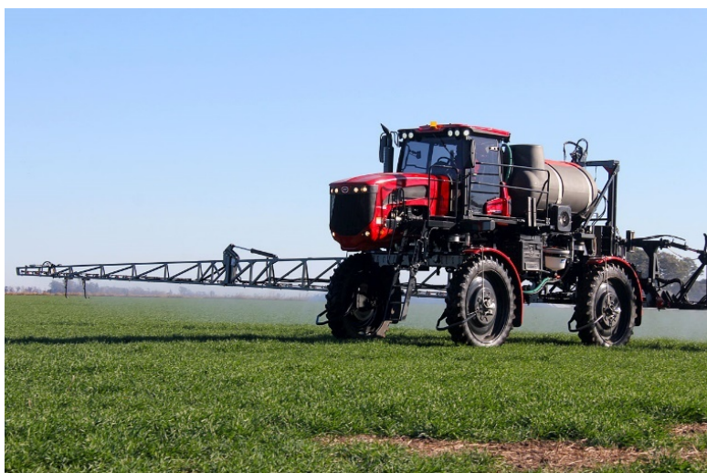
Figura 94: Las pulverizadoras autopropulsadas o “mosquitos” presentan el centro de gravedad muy elevado lo que las vuelve inestables
