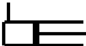
Figura 201: Simbología para un cilindro de simple efecto
