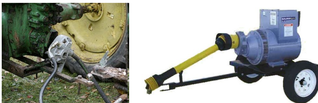
Figura 161: TPP accionando un motor hidráulico (Izquierda) Grupo electrógeno que demanda potencia rotacional a través de una barra cardánica (Derecha)
