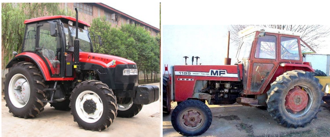
Figura 92: Tractor de batalla chica, 2,2m (Izquierda) y tractor de gran batalla, 2,65m (Derecha)
