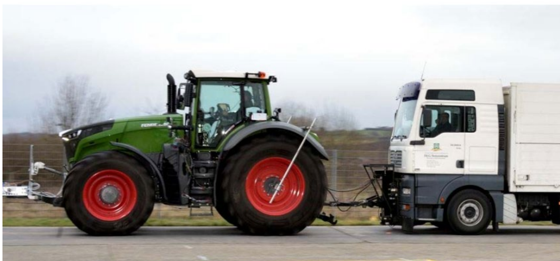
Figura 256: Camión dinamométrico utilizado para la prueba de tracción (OCDE, 2019)
