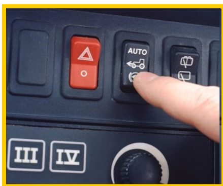
Figura 177: En los tractores FWA la tracción delantera se conecta y desconecta desde la cabina (Izquierda) El lastre delantero imposibilita que el eje delantero patine, solo con equipos montados se debería agregar lastre adelante (Derecha)
