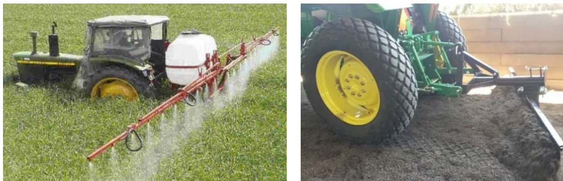
Figura 228: Aperos que se trabajan en Control de Posición. Pulverizadora montada (Izquierda) Hoja niveladora montada (Derecha)
