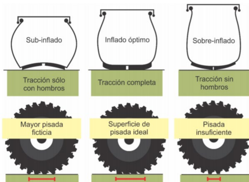
Figura 245: Tanto la presión excesiva, como la falta de presión traen aparejadas una reducción en la superficie de contacto rueda-suelo. La tendencia es que los neumáticos estén sobreinflados. Debe revisarse periódicamente esta variable para reducir el patinamiento. (INTA, Ferrari et al., 2016)
