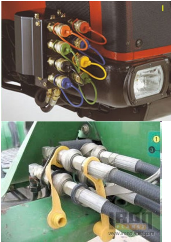
Figura 206: Salidas del circuito hidráulico protegidas por capuchones (Izquierda) Mangueras conectadas a las salidas (Derecha)
