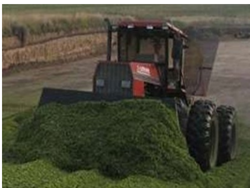
Figura 97: Situación de vuelco generada en la compactación de silos (Izquierda) Recomendación de maniobra para reducir el riesgo de vuelco ante pendiente excesiva anteroposterior (Derecha)
