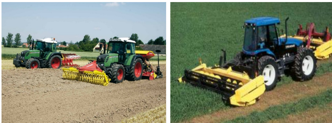
Figura 195: Tractores con equipos montados. Arado de reja y vertedera, rolo desterronador y sembradora (Izquierda) Segadoras de forraje (Derecha)
