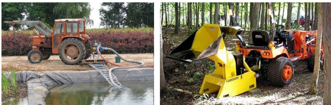
Figura 160: TPP accionando una bomba de riego (Izquierda) y una chipeadora (Derecha)
