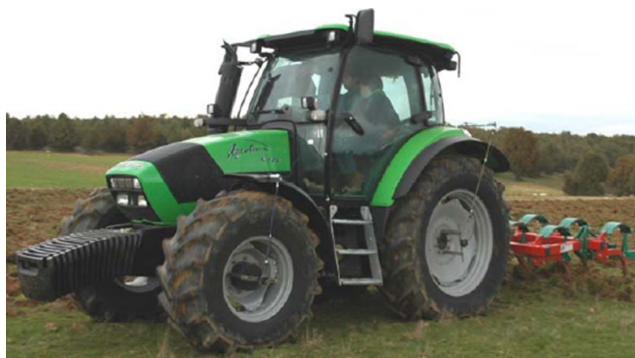
Figura 177: En los tractores FWA la tracción delantera se conecta y desconecta desde la cabina (Izquierda) El lastre delantero imposibilita que el eje delantero patine, solo con equipos montados se debería agregar lastre adelante (Derecha)
