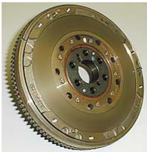
Figura 10: Izquierda: Volante de inercia con corona exterior, al mismo se acopla el embrague. Derecha: Motor de arranque actuando sobre la corona exterior del volante durante el encendido
