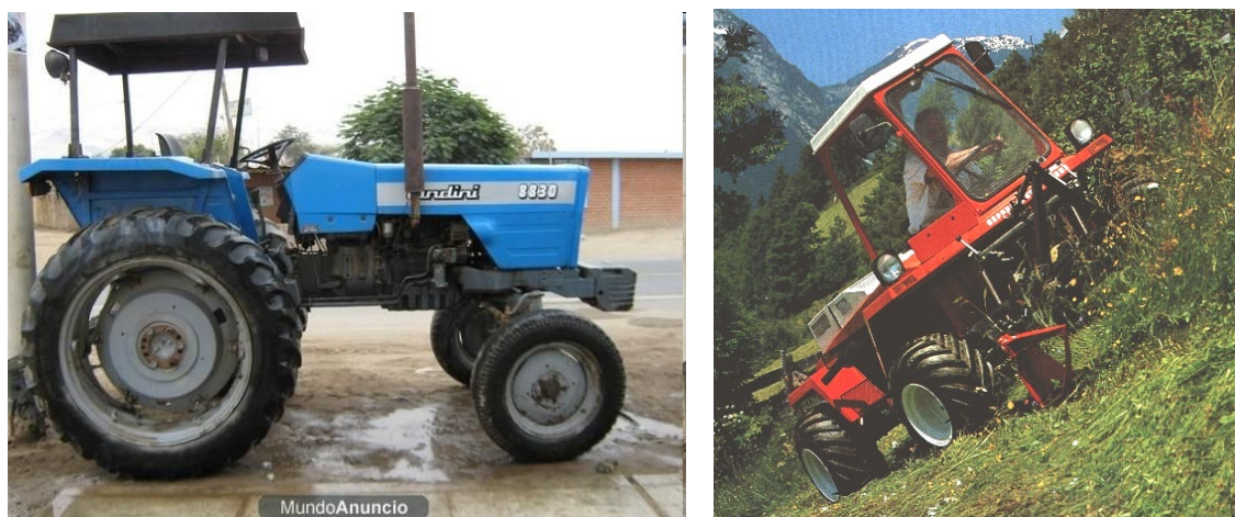
Figura 93: Tractor convencional con el centro de gravedad alto (Izquierda) y tractor especial con el centro de gravedad muy bajo apto para trabajar en laderas (Derecha)
