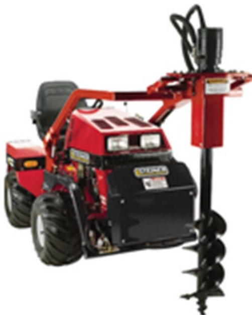
Figura 192: Hoyadora. Se aprecia en la parte superior del tornillo sinfín el motor hidráulico al que le llegan dos mangueras
