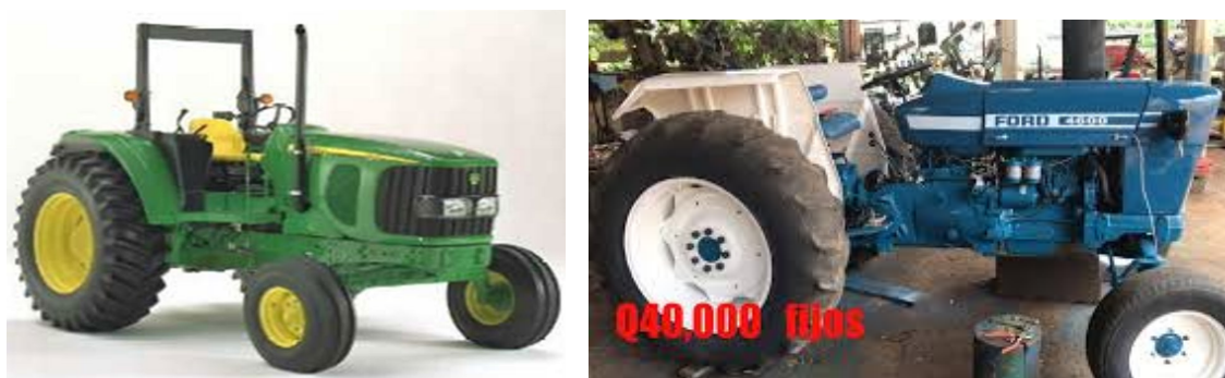
Figura 172: Tractor con chasis (Izquierda) Tractor sin chasis o monoblock (Derecha)
