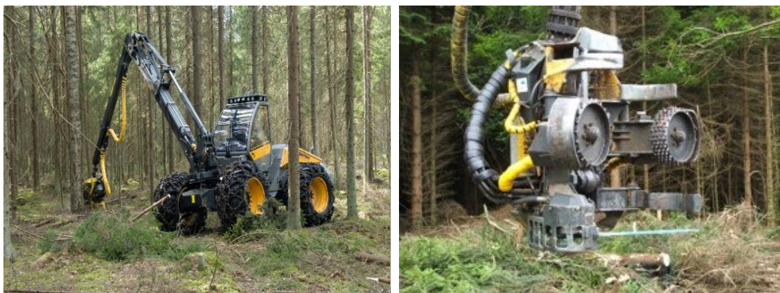
Figura 193: Izquierda: Harvester, tractor especial para cosechar árboles Derecha: Detalle del cabezal
