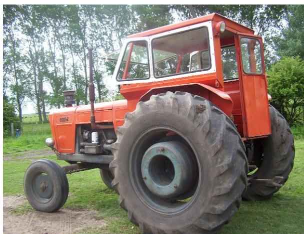
Figura 112: Las ruedas de los tractores se pueden llenar con agua para aumentar el peso estático (Izquierda). Los tractores traen un conjunto de lastres metálicos que se abulonon a los discos de las ruedas del eje trasero (Derecha)
