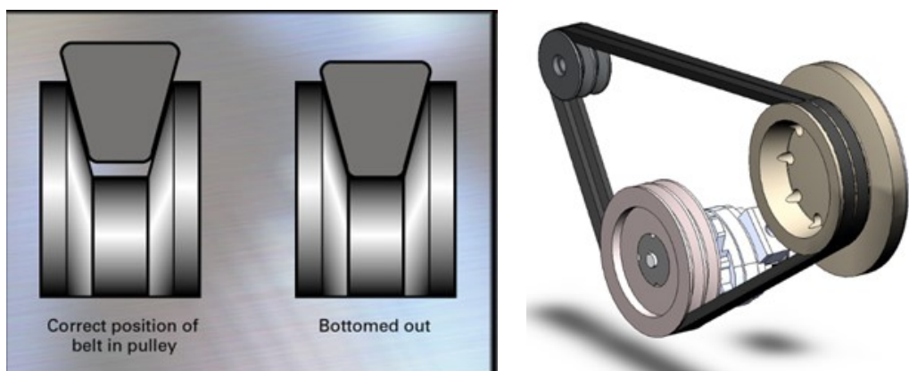
Figura 115: Transmisiones por correa trapezoidal. A la izquierda se muestra la posición correcta de la correa en la polea, y a la Derecha un tren de dos poleas en paralelo
