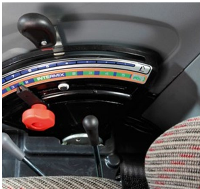
Figura 221: Palanca de elevación descenso del elevador de tres puntos. Se aprecia el indicador que guía al tractorista para clavar el implemento siempre a la misma profundidad
