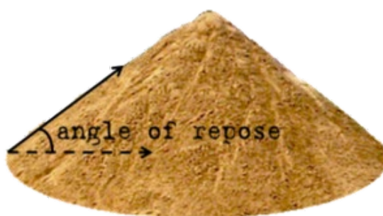
Figura 240: Talud de un suelo arenoso. El ángulo que forma la pila es el ángulo de roce interno \phi
