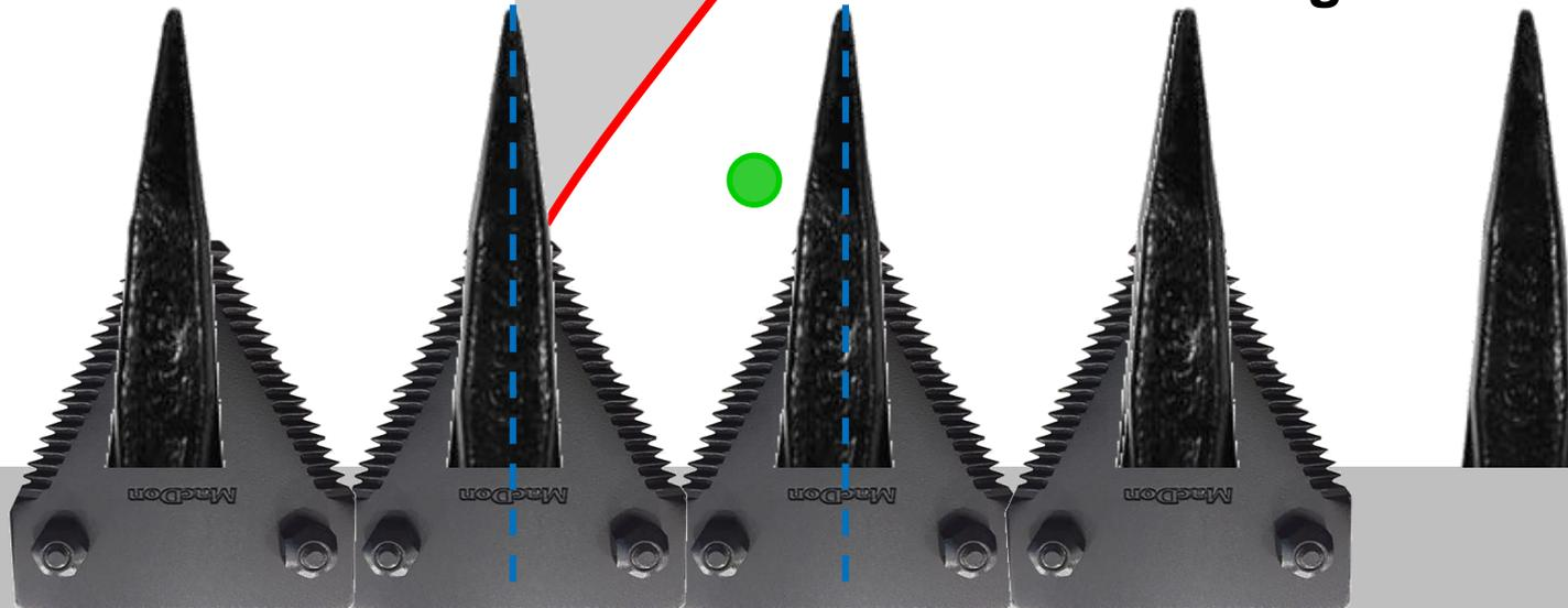
Si se aumenta demasiado la velocidad de avance, se carga demasiado cada corte
