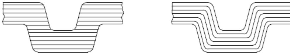
Direccionamiento de las fibras de material tras un mecanizado (izquierda) y un forjado (derecha)
