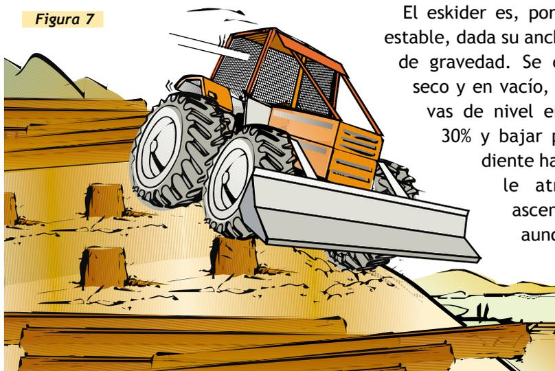
El eskider es, por diseño, una máquina muy estable, dada su anchura de eje y su bajo centro de gravedad. Se considera que con terreno seco y en vacío, puede desplazarse por curvas de nivel en pendientes superiores al 30% y bajar por líneas de máxima pendiente hasta con un 60%. Cargado, se le atribuye la posibilidad de ascender por laderas del 45% aunque dichas cifras deben ser manejadas con extrema cautela.
