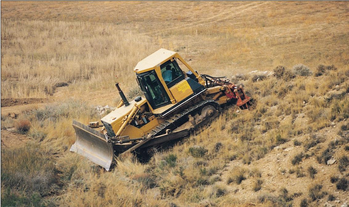
**Figura 3.- Ejemplo de cabina antivuelco.**
