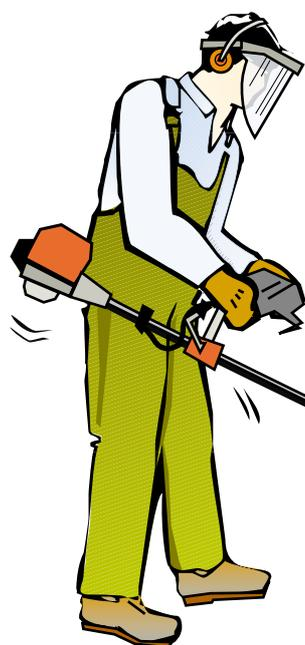
Máquinas portátiles de hasta 14 Kg de peso. Para facilitar su manejo la distribución de cargas se halla equilibrada en torno a un largo brazo, y se porta enganchada a un cinturón que se sujeta a hombros y espalda (Figura 5).
