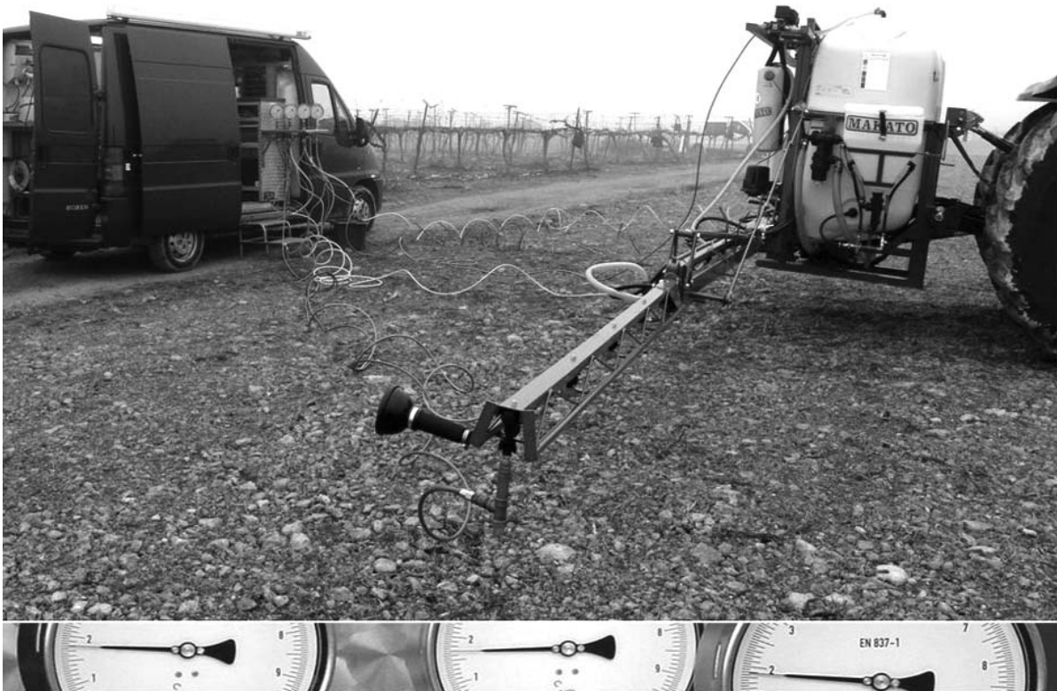
Figura 11.12. Ensayo de equilibrio de presiones de una barra de pulverización
