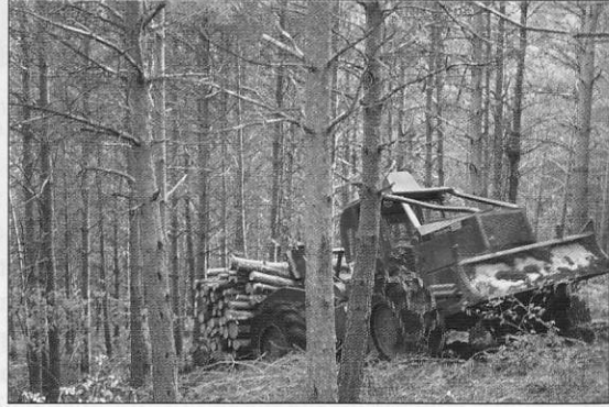
Figura 2: Desembosque en suspensión (en "paquetes") por medio de skidder.
