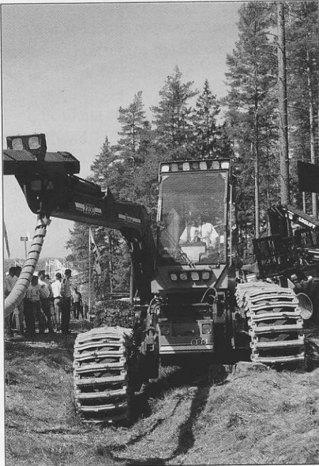
Figura 15: Vehículo de chasis nivelable, posible gracias a su transmisión hidrostática.
