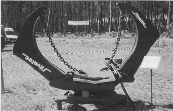
Figura 12: Skidder de grapa y pluma. Detalle de una grapa.
