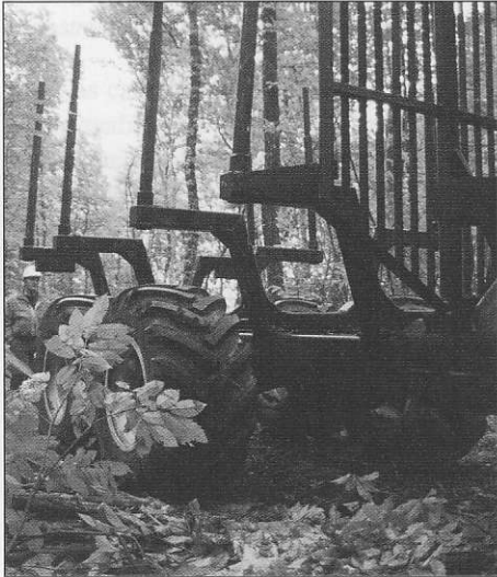
Figura 8: Diseño de la caja o remolque para apilado longitudinal (madera larga).
