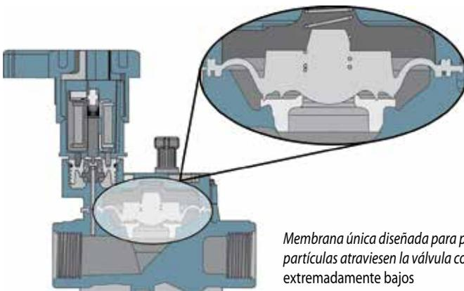
Membrana única diseñada para permitir que las partículas atraviesen la válvula con caudales extremadamente bajos
