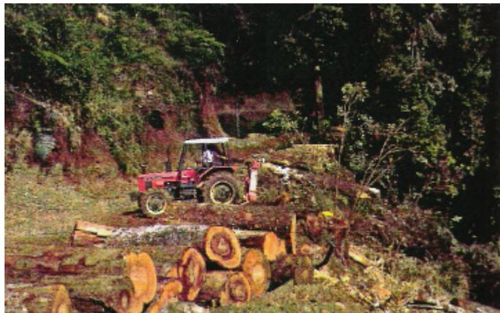
**Figura 4.26:** El arrastre mediante tractor con cabrestante. (Gayoso)
