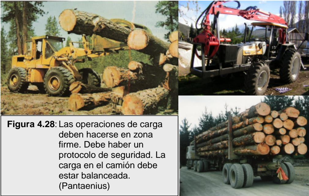
**Figura 4.28:** Las operaciones de carga deben hacerse en zona firme. Debe haber un protocolo de seguridad. La carga en el camión debe estar balanceada. (Pantaenius)
