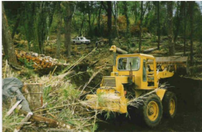
**Figura 4.5:** Cargadora frontal trabajando en la construcción de camino secundario (APN)
