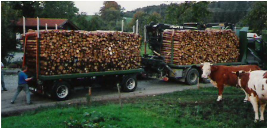
**Figura 4.31:** Carga transversal de leña (Pantaenius).
