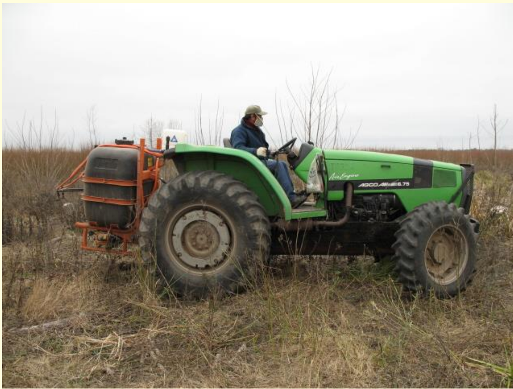
Pulverizadora de 600 l con botalón corto y enganche de tres puntos; aplicación invernal de glifosato + preemergente.
