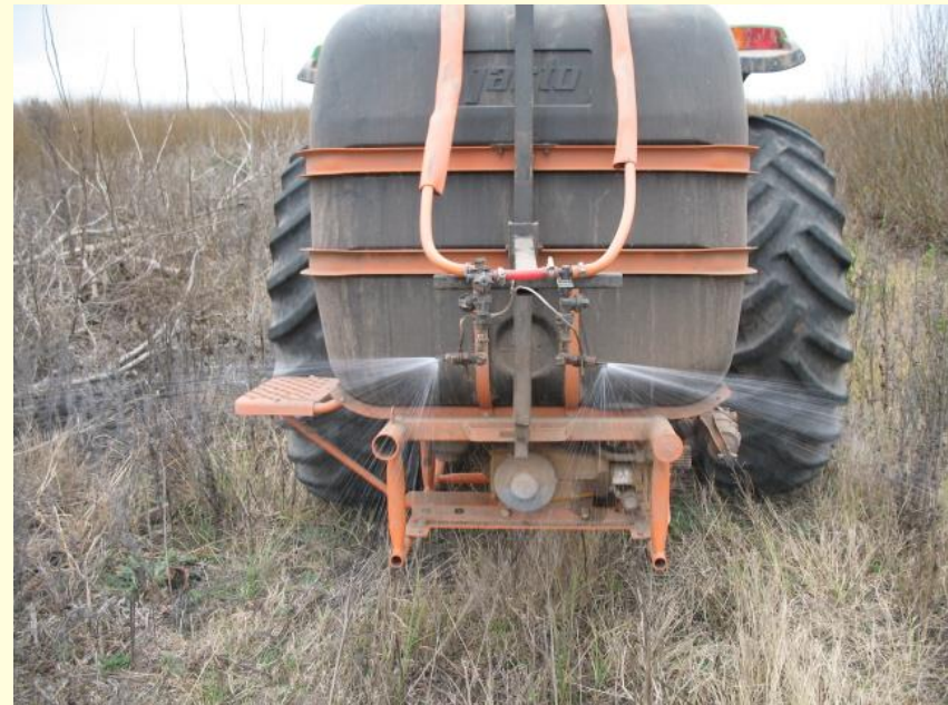
Pulverizadora de 600 l con botalón corto y enganche de tres puntos; aplicación invernal de glifosato + preemergente.
