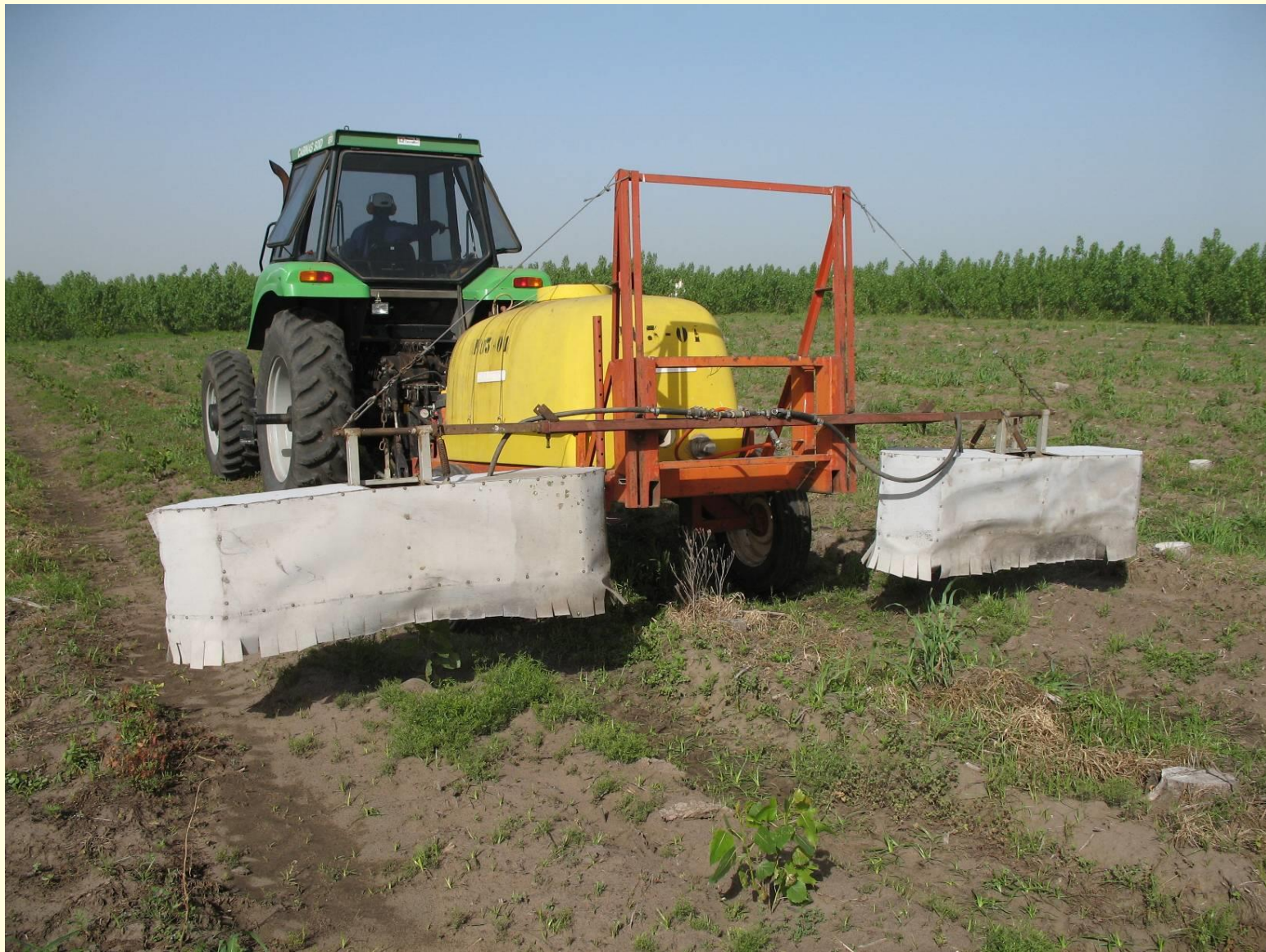
Aplicación en bandas de una mezcla de tanque con herbicidas postemergentes en álamo (primavera)
