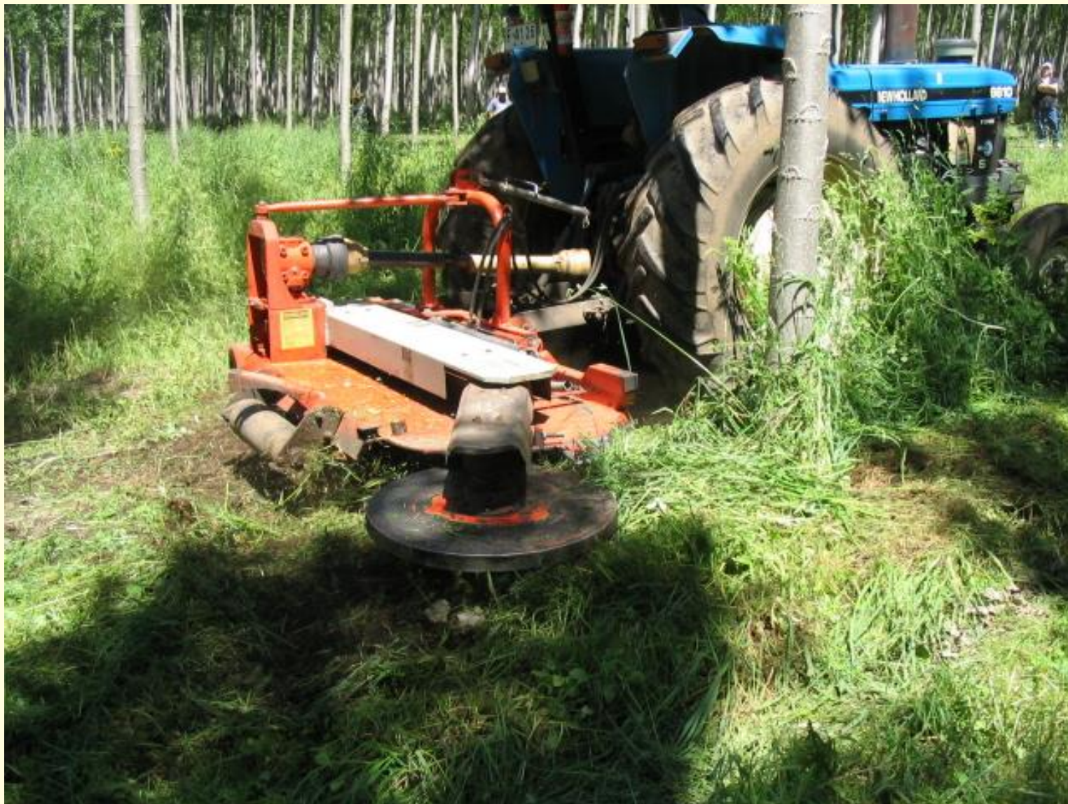
Desmalezadora de tres puntos con brazo móvil para cortar alrededor de los fustes
