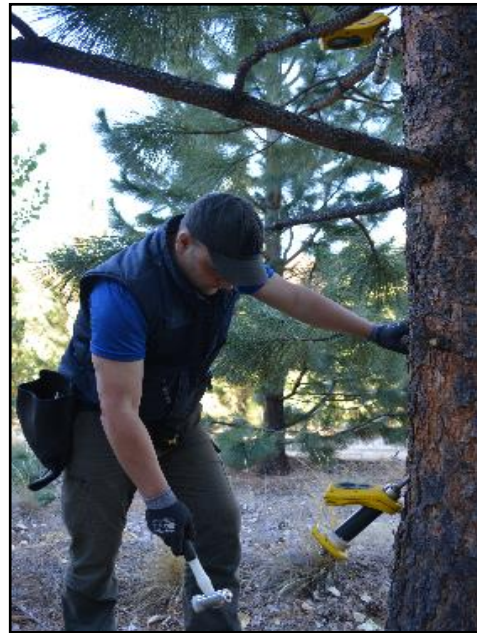
Foto 1b. Medición de velocidad de propagación de onda acústica sobre el fuste con equipo portátil ST300 (Fibre-Gen, NZ).
