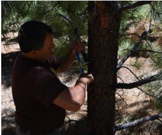
Foto 1a. Extracción de tarugo de madera para cálculo de densidad en verde
