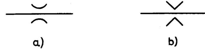
Figura 43.—Símbolos utilizados para representar los orificios o válvulas reguladoras de caudal. a) Válvula cuyo caudal de paso depende de la viscosidad del aceite. b) Válvula en la cual la viscosidad del aceite no influye en el caudal que la atraviesa.
