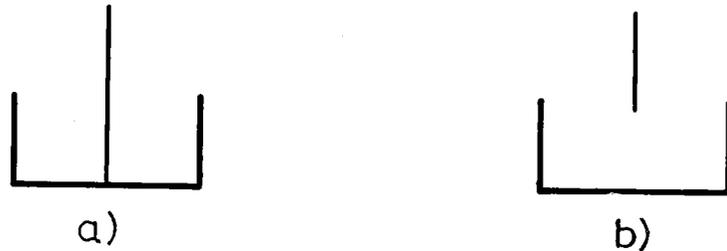
Figura 3.—Símbolos del depósito cuyo aceite está a presión atmosférica y de la tubería que en él entra. a) Tubería que desemboca por debajo del nivel del líquido. b) Tubería que desemboca por encima del nivel del líquido.
