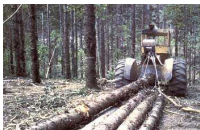
Tractor de desembosque con ruedas reuniendo una carga de trozas para el desembosque en una plantación forestal tropical. El arco integral permite levantar del suelo el extremo frontal de la carga durante el arrastre.
