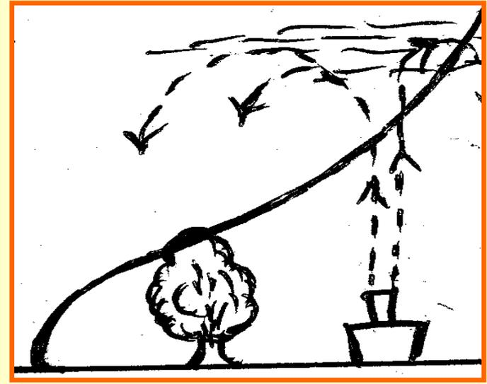
El aire caliente alcanza antes el techo. Calentamiento por convección más eficiente.
