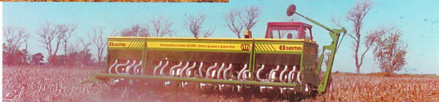
Tractor 90 Hp. sembrando trigo con 21 surcos neumáticos, ... en el INTA OLIVEROS (Sta. Fe).
