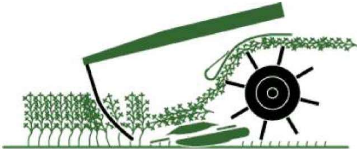
Figura 4.43. Esquema de trabajo de un acondicionador de dedos o impeller.
