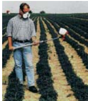
FIGURA III 35: Utilización manual del cabezal rotativo
