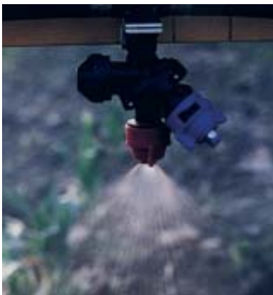
FIGURA IV.37: Vista y esquema de un pico múltiple con válvula antigoteo
