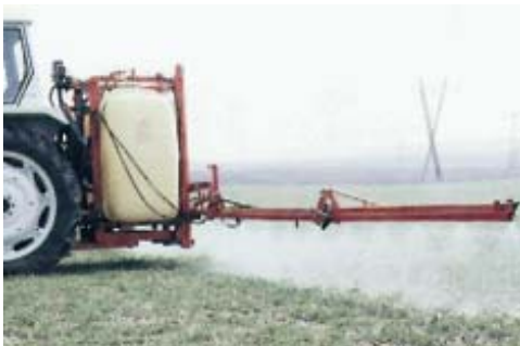
Figura 1.1: Máquina pulverizadora de chorro proyectado
