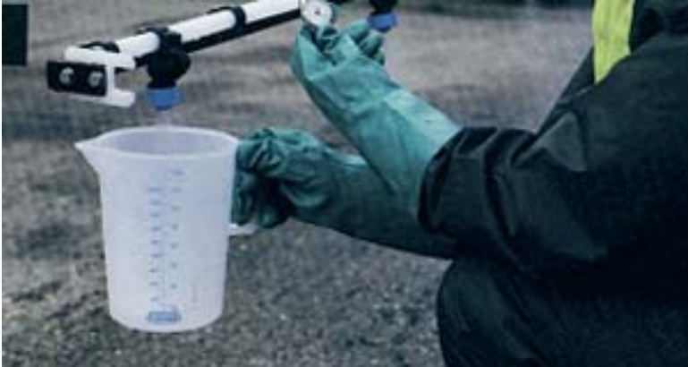
FIGURA V. 5 Operador observando el caudal del pico
