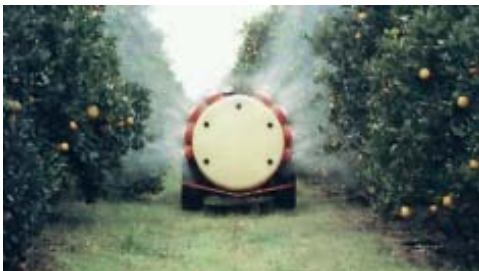
Figura 1.3: Máquina pulverizadora de chorro transportado.
