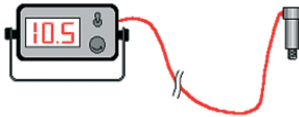
FIGURA IV.29: Esquema de un transductor de presión.
