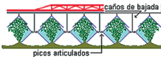
FIGURA IV.39: Esquema de una aplicación con tubos de bajada y vista de un pico múltiple articulado orientable (derecha)
