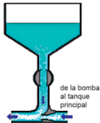
FIGURA IV.7: Esquema del dispositivo de carga de plaguicidas
