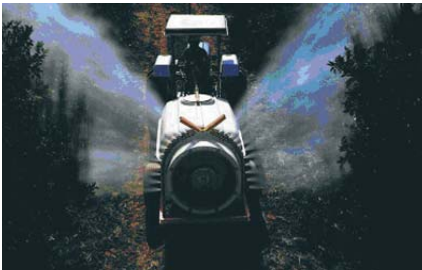
FIGURA III 29: Pulverización en un monte frutal con máquina de chorro transportado
