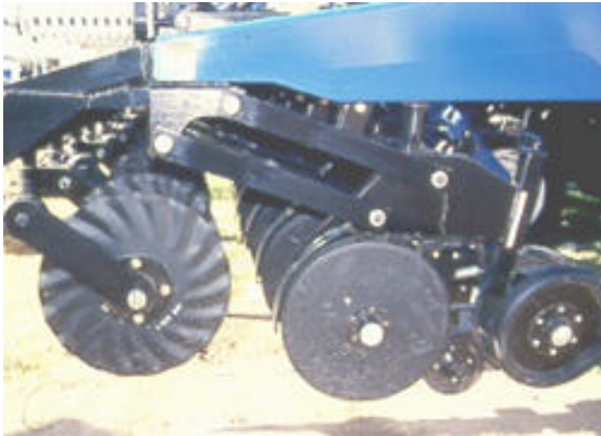
Fig. 50: vista lateral del tren de siembra de Victor Juri que resume el nuevo concepto.
