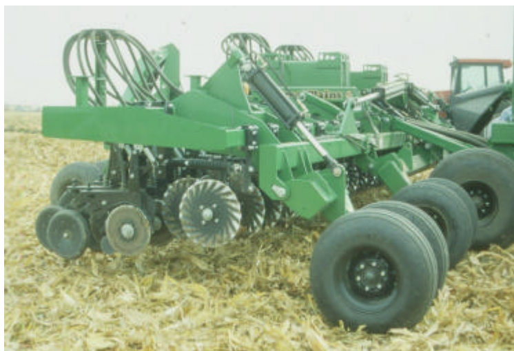
Fig. 49: cuerpo de siembra de sembradora air drill para siembra en rastrojos exigentes. Cuchilla turbo, paralelogramo, doble disco y rueda tapadora limitadora.
