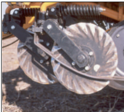
Fig. 45 y 46: patines fijadores de rastreo que además cumplen con la finalidad de evitar la remoción exagerada de la cuchilla cuando sale del suelo.
