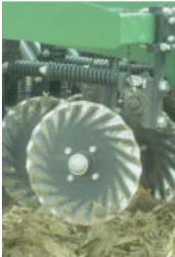
Figs. 9 y 10: cuchilla turbo, su colocación y principio agronómico de funcionamiento basado en la entrada y salida de las ondas tangenciales de la cuchilla. (Eficiencia de corte y limpieza de rastrojo en la línea).
