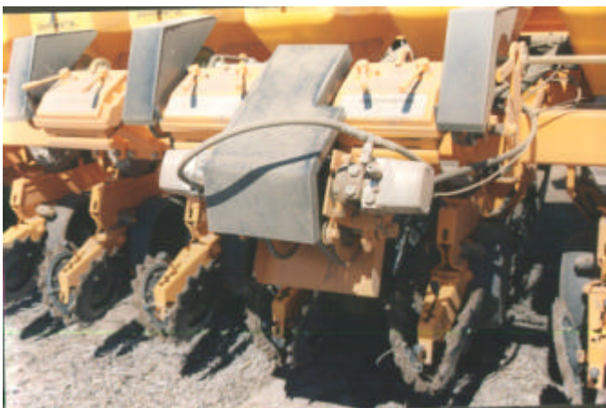
Fig. 36: 2 motores variadores hidráulicos, uno para semilla y otro para fertilizante.
