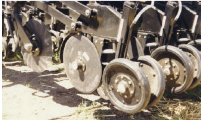
Fig. 51: detalle del tren de siembra con regulación de profundidad trasera por doble rueda en camellón.
