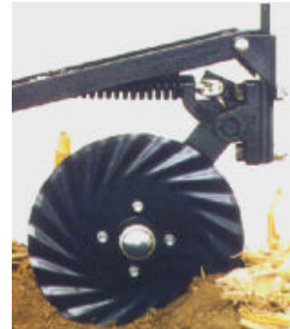
Figs. 9 y 10: cuchilla turbo, su colocación y principio agronómico de funcionamiento basado en la entrada y salida de las ondas tangenciales de la cuchilla. (Eficiencia de corte y limpieza de rastrojo en la línea).
