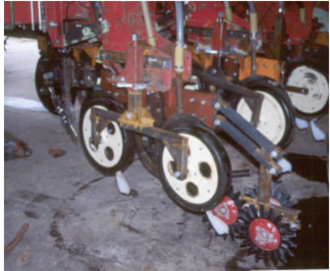
Figura 25: Tren de siembra de la sembradora prototipo del Dr Beck de la Universidad de Dakota del Sur, que marca una tendencia para el año 2.005.
