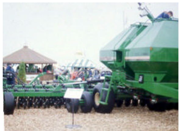
Figs. 47 y 48: sembradoras air drill de gran ancho de labor. Tanque de semilla y fertilizante separado de los cuerpos de siembra. Dosificación mecánica y traslado neumático.
