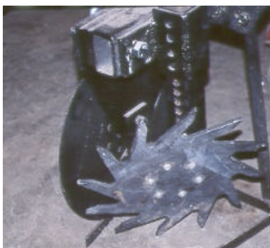
Figs. 18, 19, 20 y 21: diferentes tipos de barredores de rastrojo articulados, fijos y su colocación en el cuerpo de siembra.
