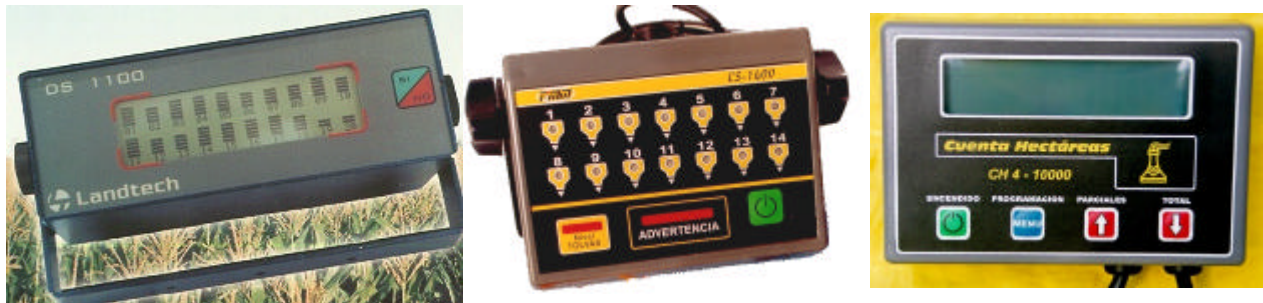
Fig. 33: monitores de siembra nacionales Landtech y TIMM con información útil sobre el funcionamiento de la sembradora.
