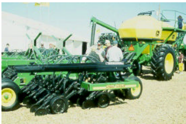
Figs. 47 y 48: sembradoras air drill de gran ancho de labor. Tanque de semilla y fertilizante separado de los cuerpos de siembra. Dosificación mecánica y traslado neumático.
