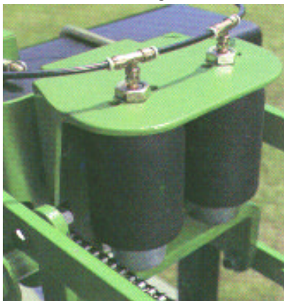
Figura 23 y 24: Pulmones neumáticos en los paralelogramos de la sembradora de grano grueso (John Deere) y pistones neumáticos (Jumil Brasil) de presión sobre los cuerpos para uniformar la profundidad de siembra.
