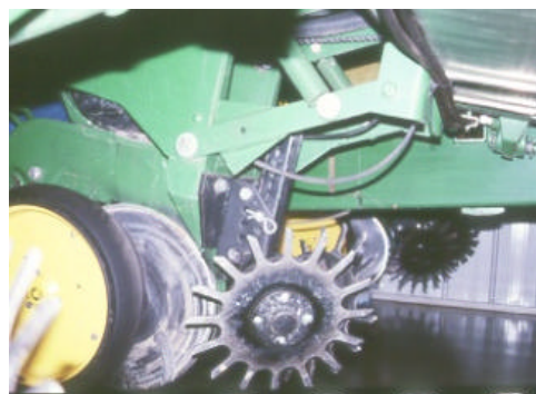
Figs. 18, 19, 20 y 21: diferentes tipos de barredores de rastrojo articulados, fijos y su colocación en el cuerpo de siembra.
