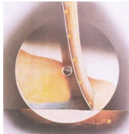
Figura n° 5: ubicación correcta en el tren de siembra
