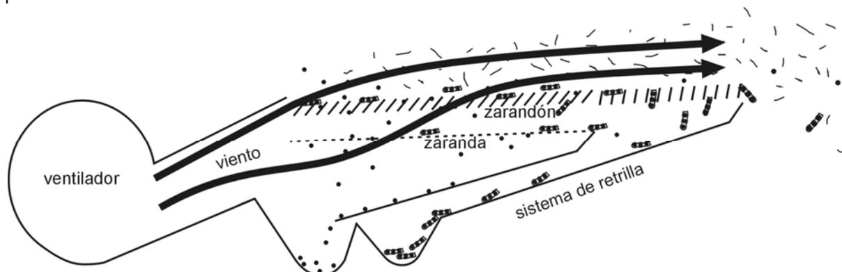
Fig. 64 Esquema del flujo de aire en el sistema de limpieza.
