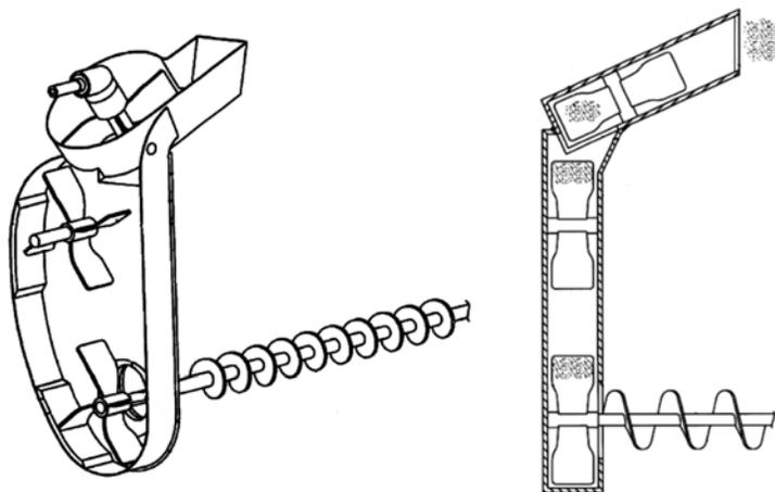
Fig. 65 Sistema de retrilla independiente. El material no es enviado al sistema de trilla nuevamente para no sobrecargarlo y se trilla por impacto en este dispositivo. Las paletas miden el volumen de material a trillar (Schmidt & Matousek, 2006).
