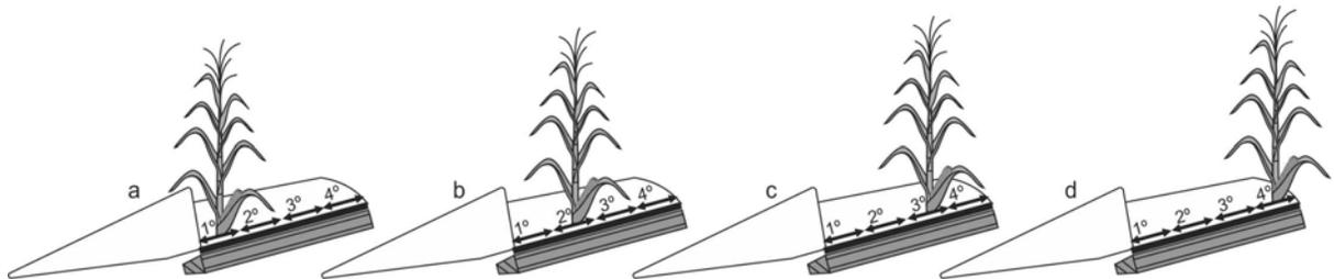
Fig. 36 Posición donde se desprende la espiga según el ajuste del régimen de giro de los rolos y la velocidad de avance.
