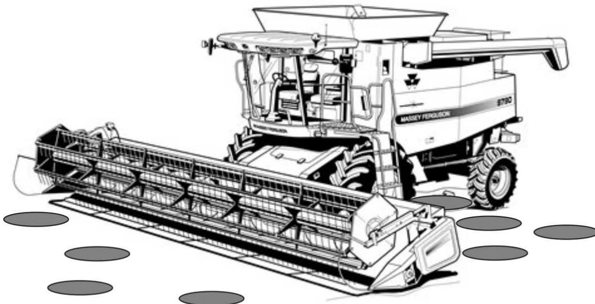
Fig. 73 Previo al paso de la cosechadora se miden pérdidas precosecha y durante el paso de la misma se vuelve a medir para diferenciar las pérdidas de cosecha por cabezal y por cola.
