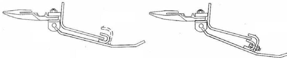
Fig. 27 El patín es la única alternativa para regular la altura de corte cuando el cabezal trabaja flotando.
