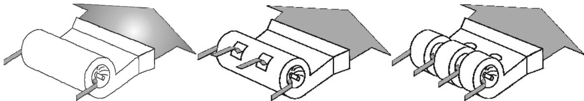
Otra alternativa han sido los ventiladores de flujo cruzado, que son de construcción similar a los centrífugos pero el ingreso del aire no se produce en los extremos del eje de rotación, sino tangente a este, de la misma manera que la salida del mismo. Por tal motivo el flujo del aire cruza al ingreso y a la salida las aletas del ventilador.
