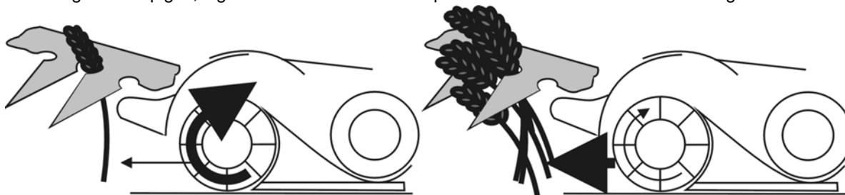
Fig. 41 Efecto de la regulación de la velocidad de giro del rotor.
