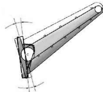
Fig. 45 Variación del ángulo de acople al cabezal.
