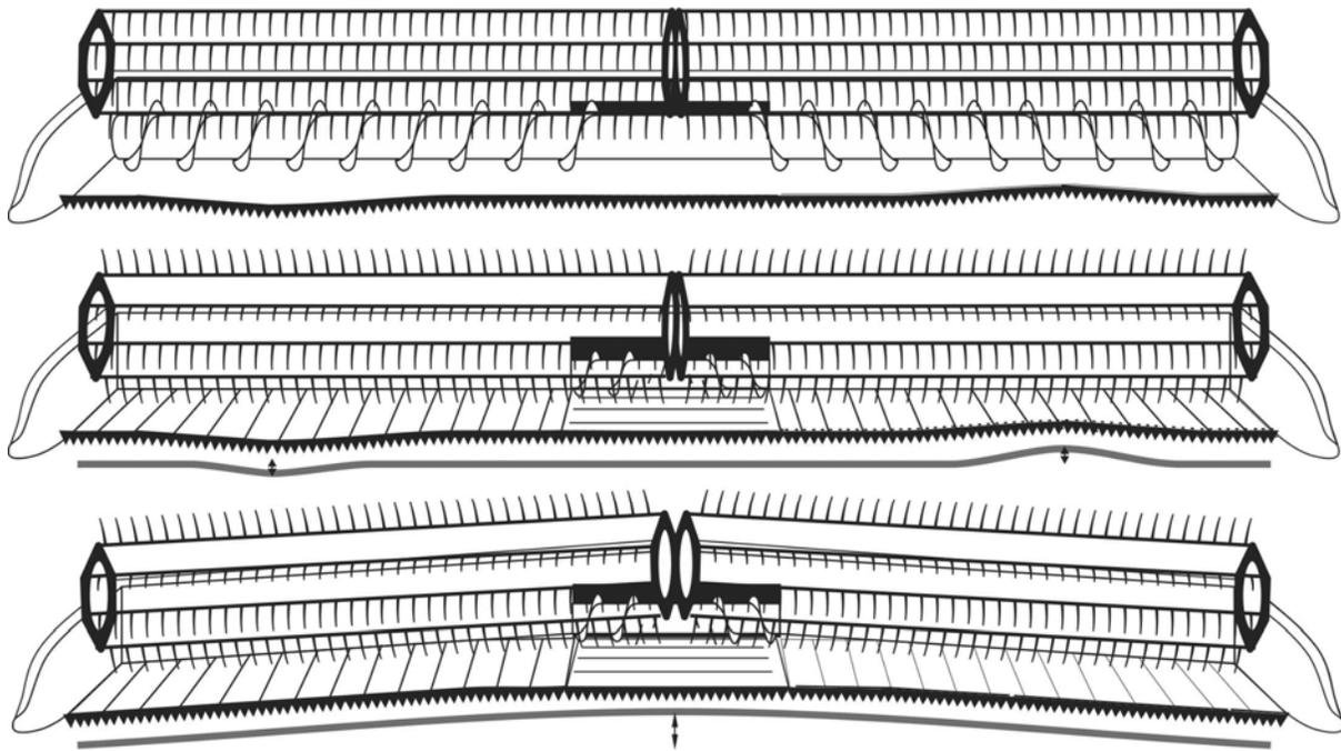
Fig. 25 Diferentes diseños de cabezales con barra de corte a) con sinfín, b) con lonas y barra de corte flexible c) con lonas y barra de corte rígida articulada.
