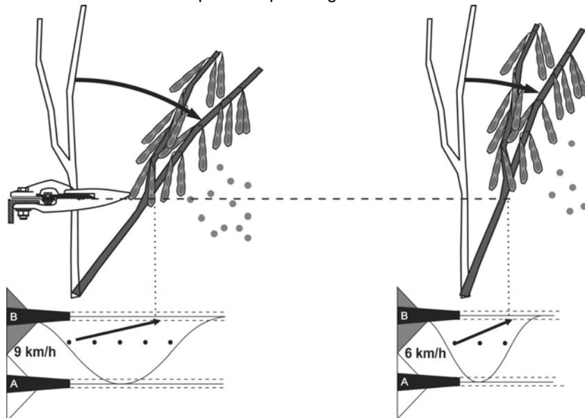
Fig. 16 El aumento de la velocidad de avance incrementa la distancia que se desplaza una planta hasta que es cortada, provocando una mayor inclinación de la misma y un aumento de pérdidas de granos.
