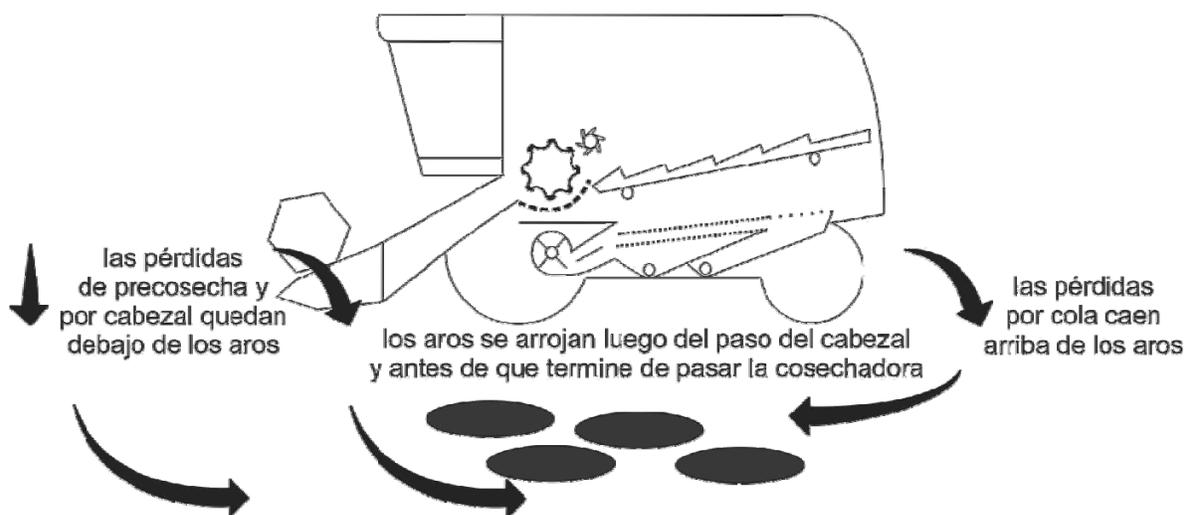
Fig. 76 Metodología de medición de pérdidas del INTA PRECOP.
