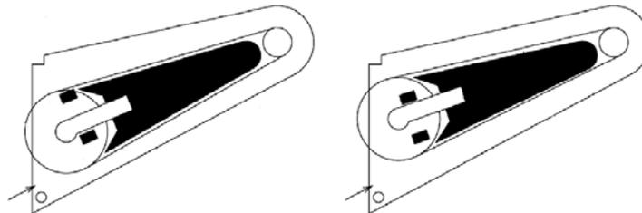
Fig. 44 Acarreador con paso variable en función del índice de alimentación.
