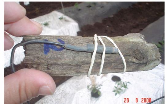
Figura 31. Sensor de platino para registrar temperatura de suelo
