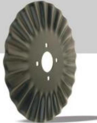
➤ Es una cuchilla adecuada para suelos franco arcillosos, muy utilizada en la siembra directa, hasta que fue desplazada por la cuchilla Turbo. Debido a la menor banda labrada absorbe menores esfuerzos para penetrar el suelo. Tiene buena capacidad de corte de rastrojo.
