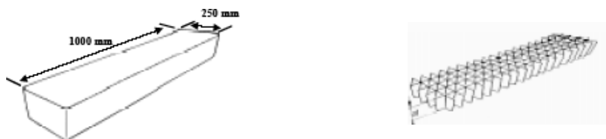
Figura 8: Esquema de cajas colectoras de 0,25 x 1m y reticulado de cartón usado para evitar rebotes.
