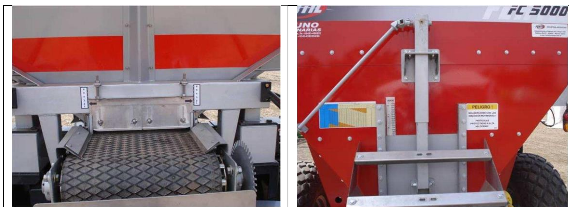
Figura 5: Variación del caudal erogado en fertilizadoras de gran ancho de trabajo. Se modifica la apertura de la compuerta y/o la velocidad de la cinta transportadora. En la imagen de la derecha se observa una tabla indicativa del caudal erogado en función de la altura de la compuerta y la velocidad de la cinta
