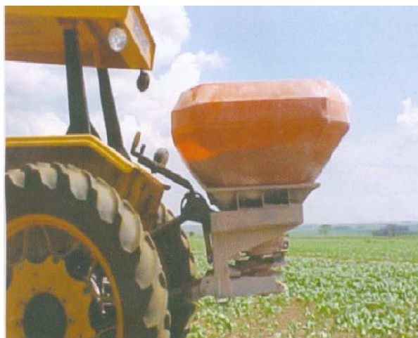
Figura 2: Fertilizadora montada. Debe verificarse la altura del dosificador (se trabaja en control de posición) y la nivelación anteroposterior y transversal
