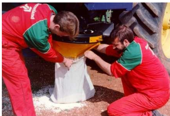
Figura 3: Diferentes kits de calibración para determinar y ajustar el caudal por minuto que eroga el distribuidor. El material es recuperado en un bolsón
