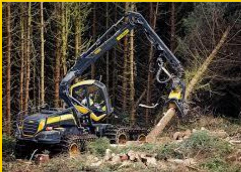
El procesamiento puede incluir en forma total o parcial descortezado, desrame, tronzado, medición, clasificación y apilado.
