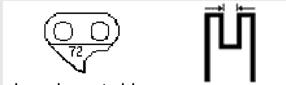
La longitud de la cadena está determinada por el recuento del número de eslabones. Entre los ejemplos comunes se encuentran la longitud 70 para la cadena "D" o "72" y la longitud 56 para la cadena "S" o "91".
