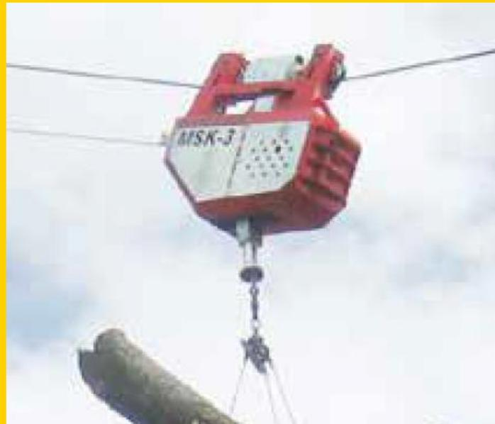
El carro se monta en un cable aéreo y está impulsado por cables unidos a cada extremo o de un solo extremo
