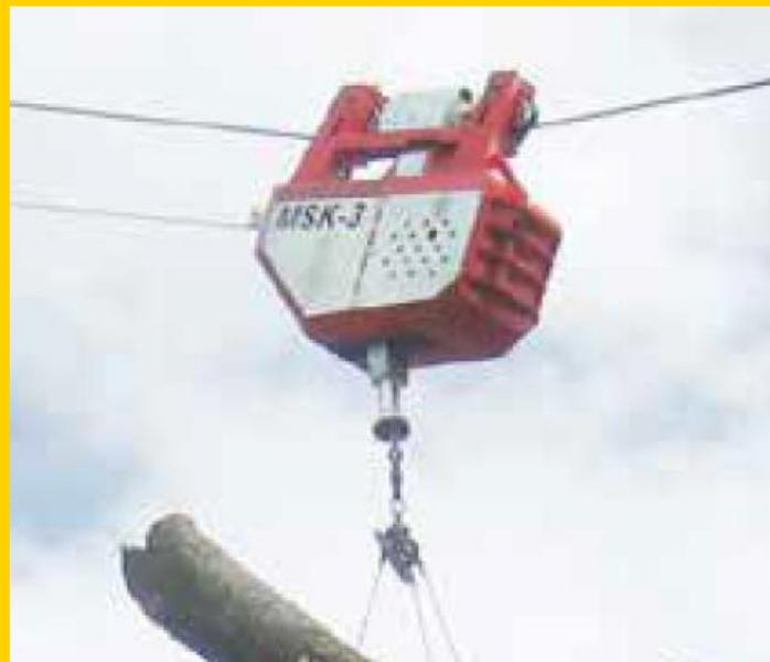
**Consisten en un carrier montado sobre una línea de acero y propulsado por un motor fijo en un extremo**
