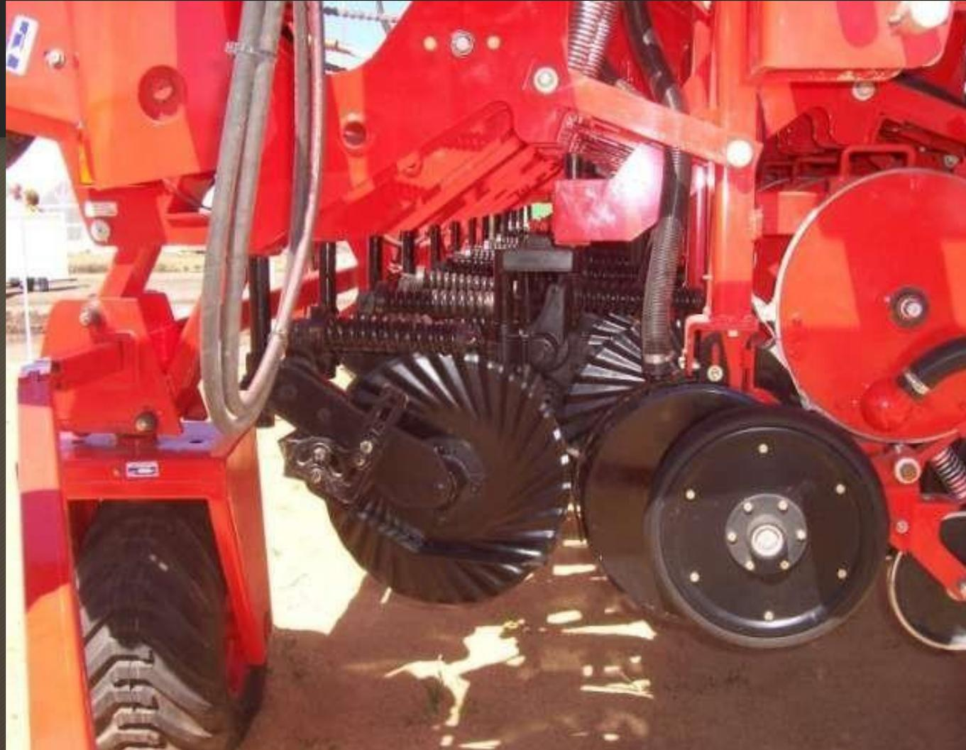
**Cuchilla ondulada tangencial con fleje para evitar la elevación de los agregados**
