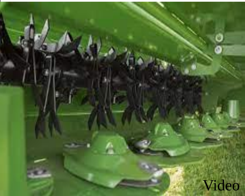
Figura 4.43. Esquema de trabajo de un acondicionador de dedos o impeller.
