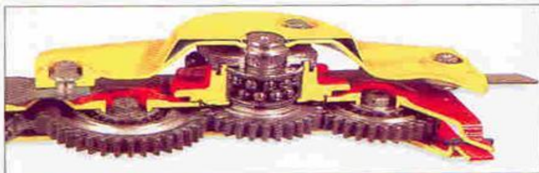
Segadora de discos ovalados. Detalle de la fijación del disco y de su sistema de accionamiento.
