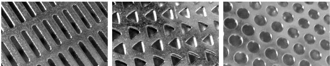
Fig. 1 Diferentes diseños de tamices para distintos cultivos. De izquierda a derecha trigo, sorgo, maíz. Las zarandas para maíz y soja son de agujeros circulares de 4 mm para soja y de 4,76 mm para maíz.
