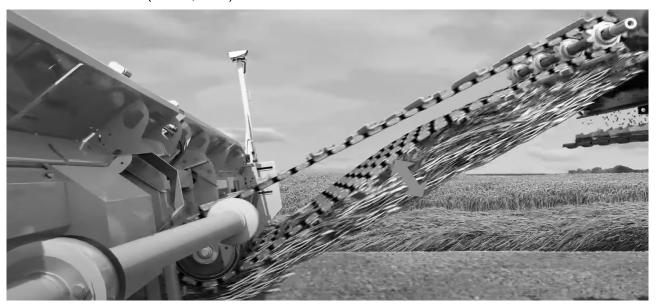
Fig. 72 El uso de sensores de flujo en el acarreador permite ajustar el tiempo de respuesta del sistema.
