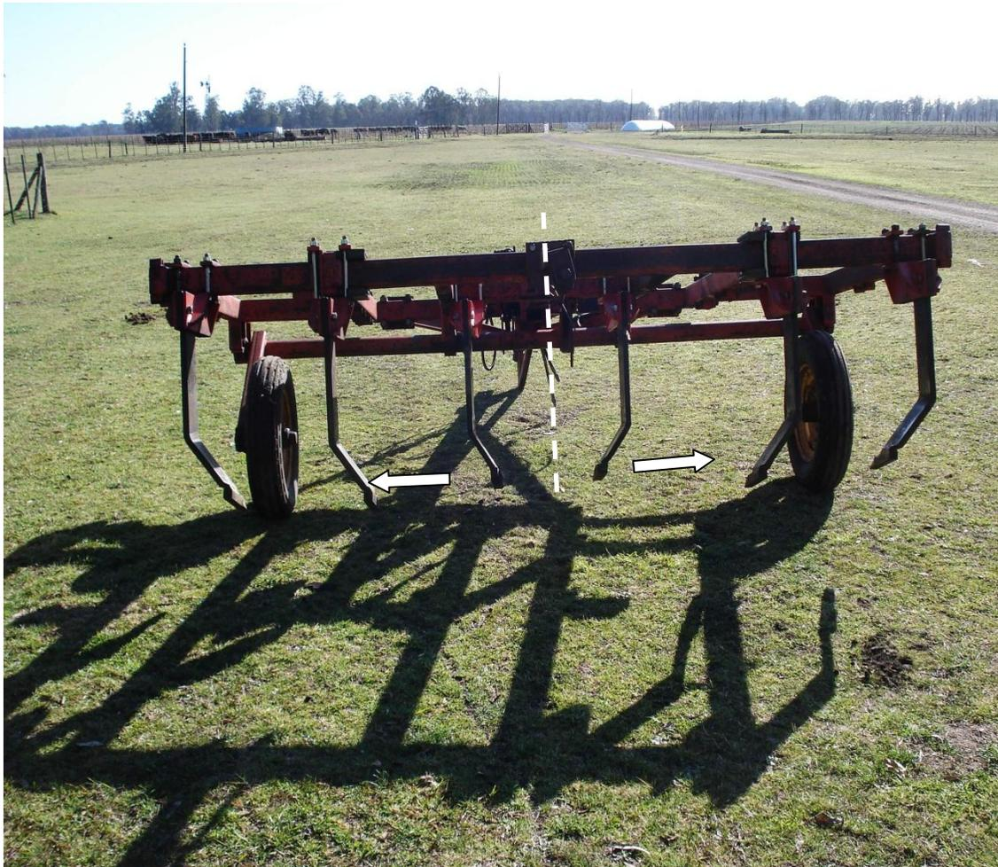
Figura 5. Vista posterior de un Paratill de arrastre con configuración de órganos en conjunto hacia el centro.
