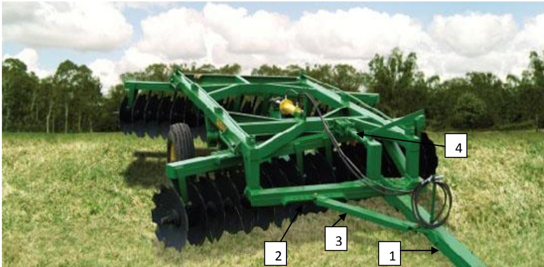
Figura 13 Vista de una rastra de tiro excéntrico con detalle de su sistema de enganche. 1) barra de enganche 2) barra transversal con alternativas de regulación en el plano horizontal; 3) barra diagonal de fijación y regulación de posición del enganche; 4) sistema de distribución y compensación del peso
