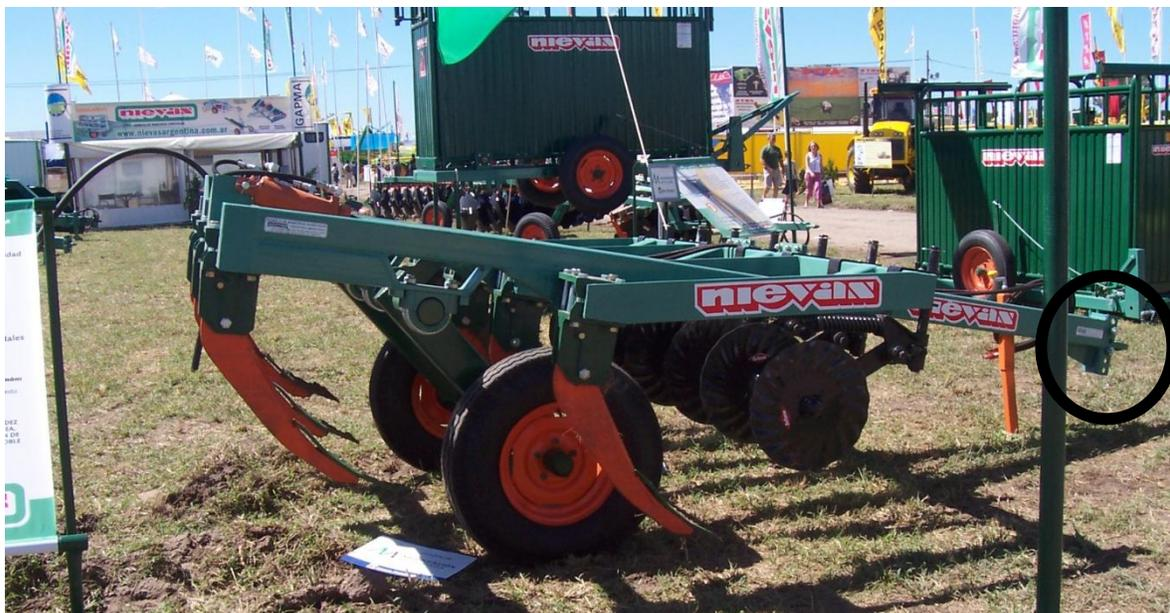
Figura 7. Vista lateral de un escarificador con lanza fija y regulación discontinua del enganche. El circulo enmarca la regulación existente en el clavijero vertical
