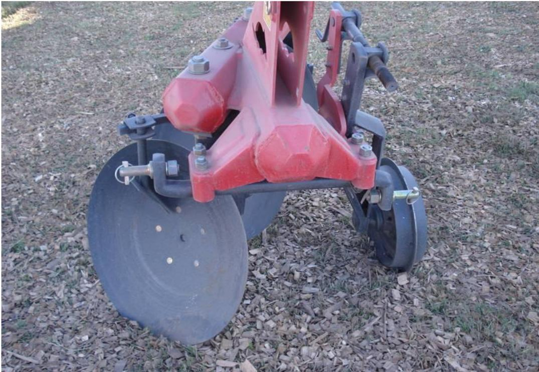
Figura 3. Detalle de un sistema de enganche característico de los implementos asimétricos. Eje acodado. Pernos de enganche. Grampas de fijación al bastidor.
