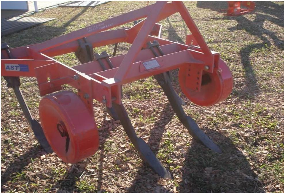
Figura 1. Vista del enganche de un descompactador montado, con puntos de acoplamiento inferiores en un mismo plano, con pernos pasantes y chavetas para el vínculo con los brazos inferiores del tractor.
