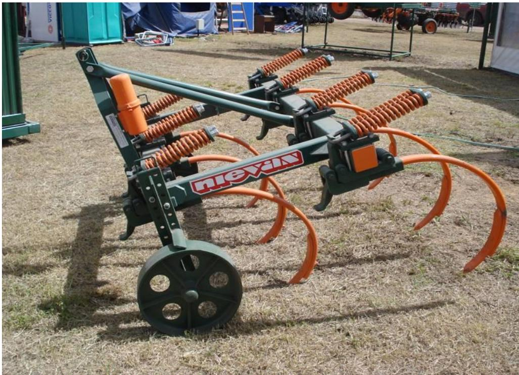
Figura 2. Vista lateral del equipo, con detalle de la torreta, punto superior de enganche y refuerzos estructurales.
