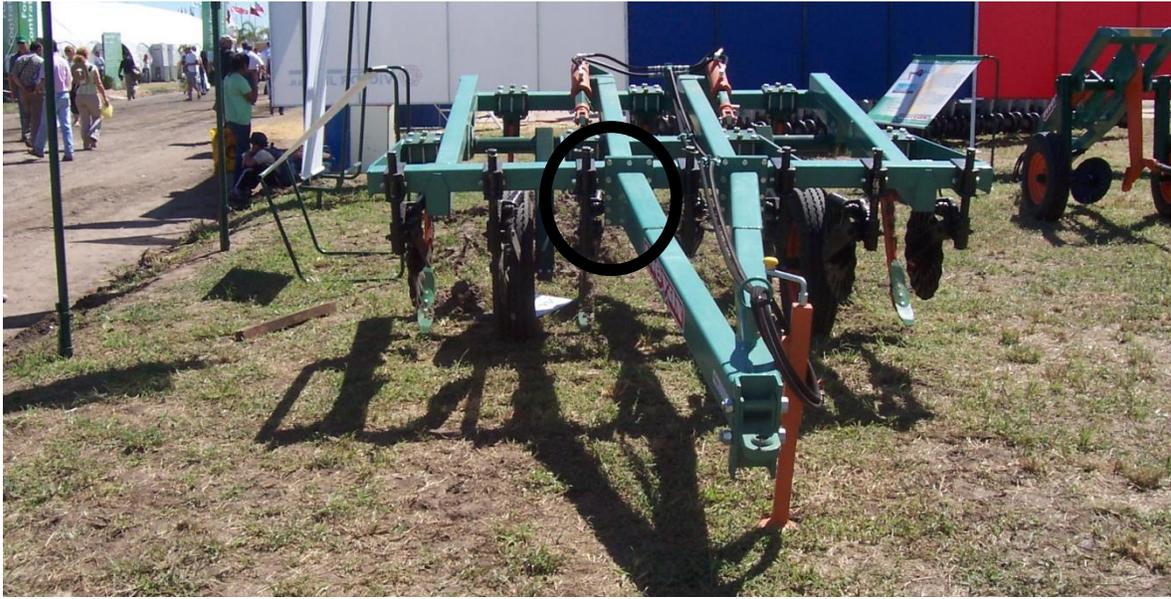
Figura 6. Vista frontal de un enganche de lanza fija con el vínculo rígido al bastidor identificado con un círculo
