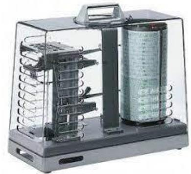
La unidad para la medición de la temperatura (termógrafo) tiene como sensor una placa metálica cuyos cambios de longitud determinan el movimiento de la plumilla que marca el valor de la temperatura sobre la cinta de papel.
