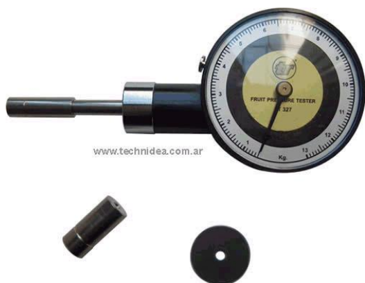
Figura 4. Penetrómetro manual Ametek, con escala en kilogramos (la escala llega hasta los 13 kgf./cm 2 )
