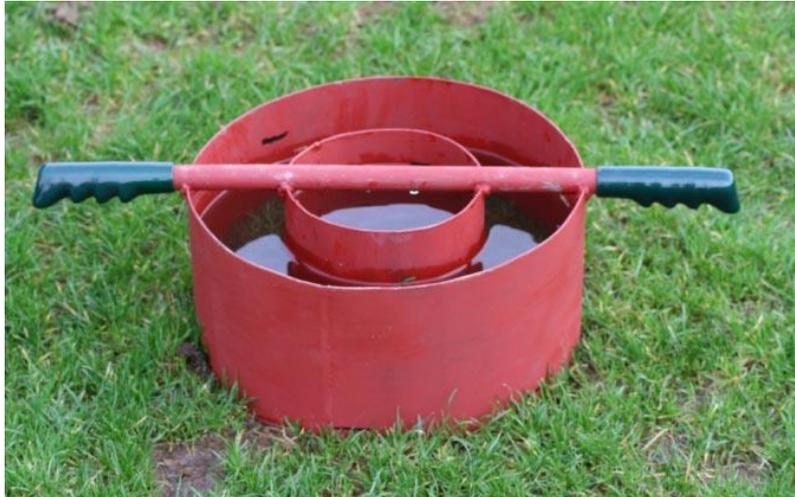
Infiltrómetro de cilindros.
