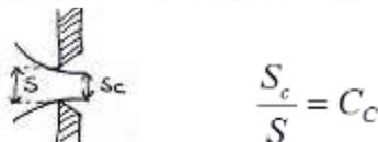
C: es el coeficiente por el cual el valor ideal de descarga es multiplicado para obtener el valor real, y se conoce como coeficiente de descarga. Numéricamente es igual al producto de los otros dos coeficientes.  $C = C_c C_v$
