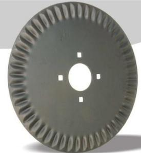
➤ Esta cuchilla es utilizada en pastura y en siembra directa con suelos arcillosos. Necesita poca fuerza vertical para su penetración en el suelo, pero mayor según el diámetro de la cuchilla. Las cuchillas con el filo liso tienen un buen giro ya que las ondas aseguran un engrane con el suelo. La cuchilla con el borde ondulado tiene un mejor corte de rastrojo.
