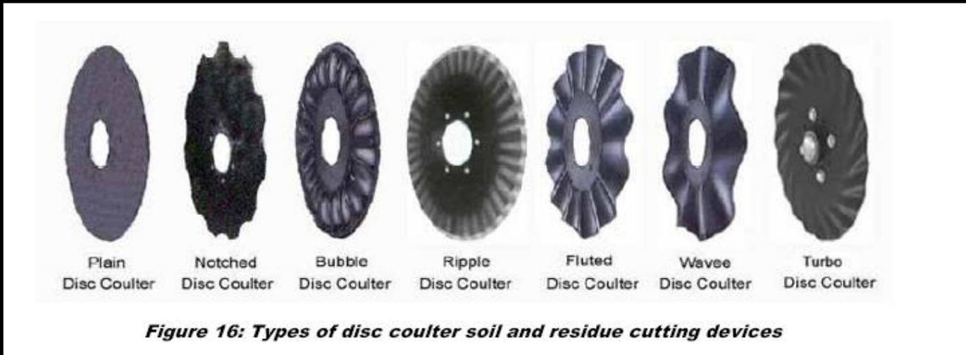
Planas    escotadas    inflada    ondulada    estriada    ondeada    turbo
