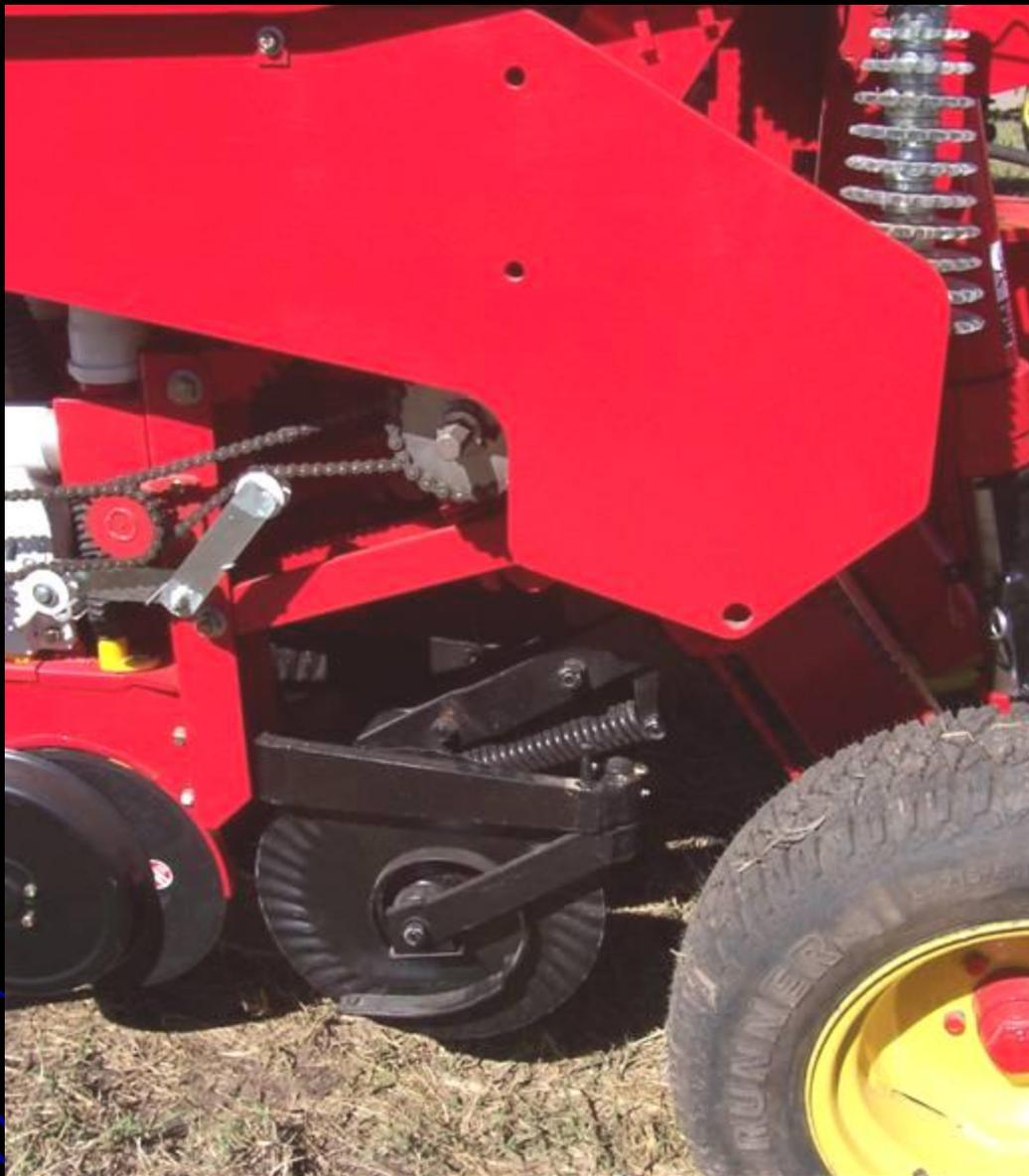
Cuchilla turbo con fleje para evitar la elevación de los agregados
