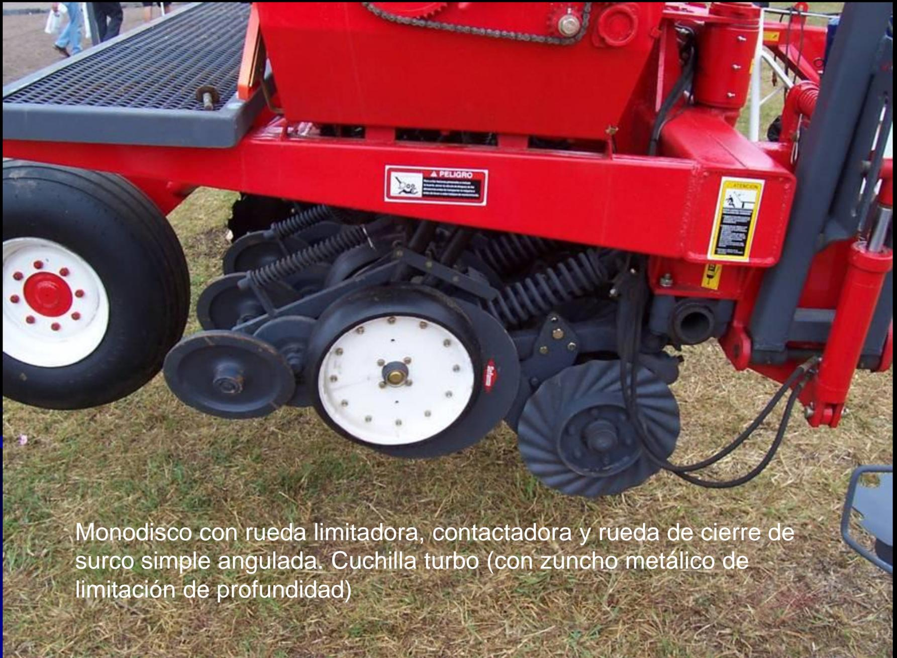
Monodisco con rueda limitadora, contactadora y rueda de cierre de surco simple angulada. Cuchilla turbo (con zuncho metálico de limitación de profundidad)
