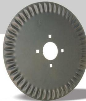
➤ Esta cuchilla es utilizada en labranza vertical, para remoción profunda del suelo y en suelos arcillosos. Necesita más fuerza vertical para su penetración en el suelo debido al gran diámetro de la misma.
