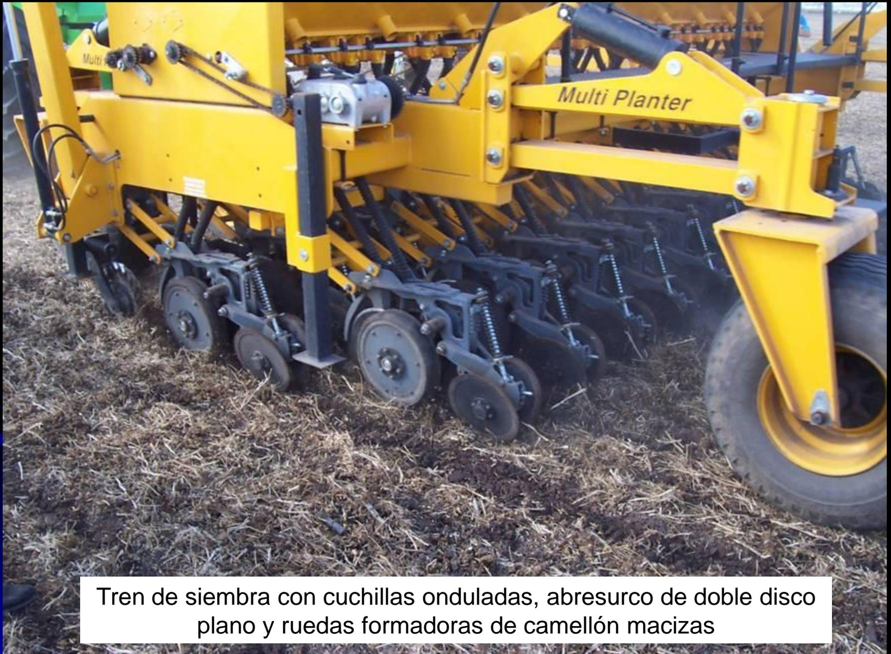
Tren de siembra con cuchillas onduladas, abresurco de doble disco plano y ruedas formadoras de camellón macizas
