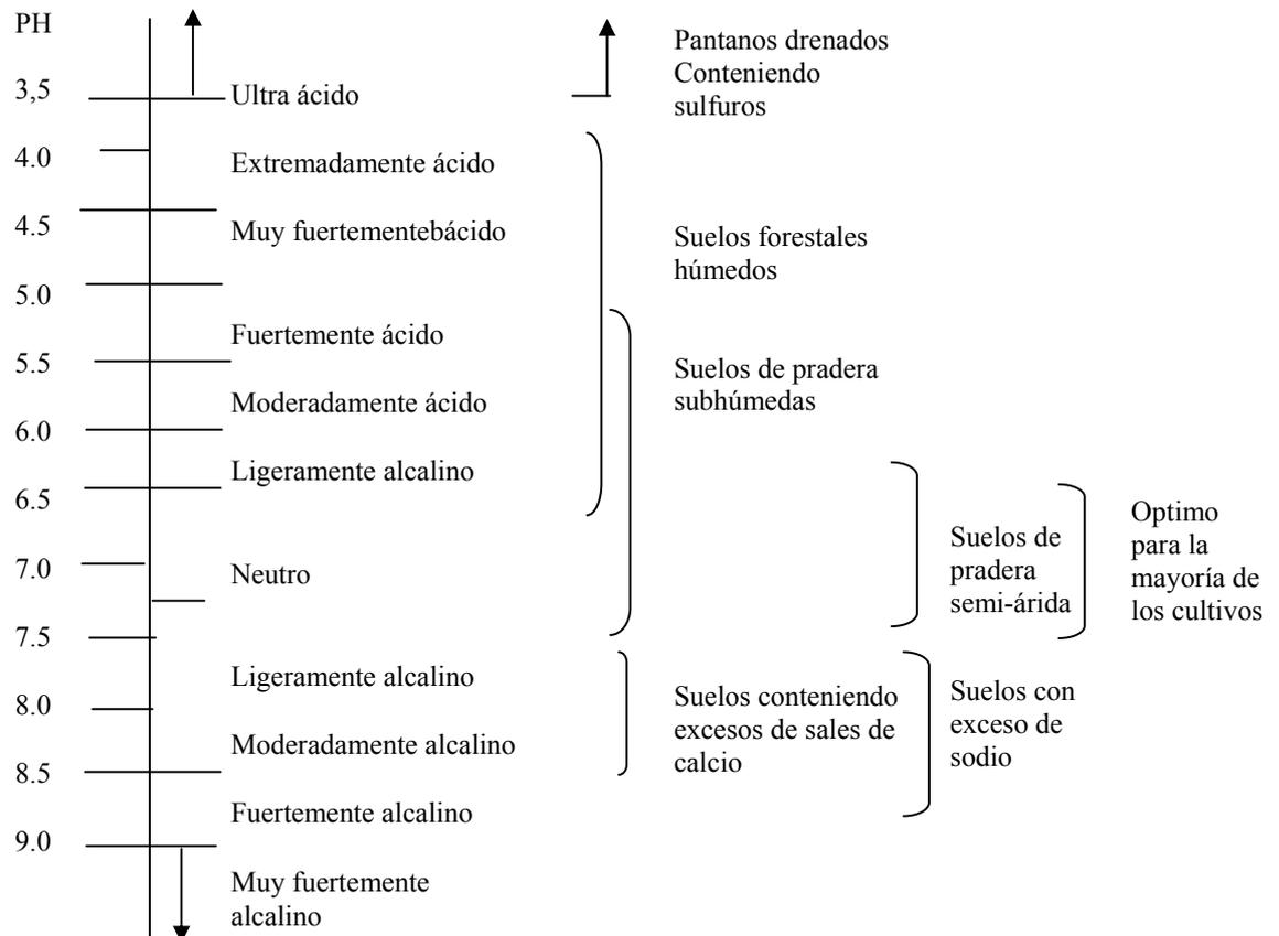
**Figura 1.** PH del suelo, rangos de las clases de pH, y condiciones edáficas asociadas. Adaptado del National Soil Survey Manual (1993) y de Troch y Thompson (1993).
