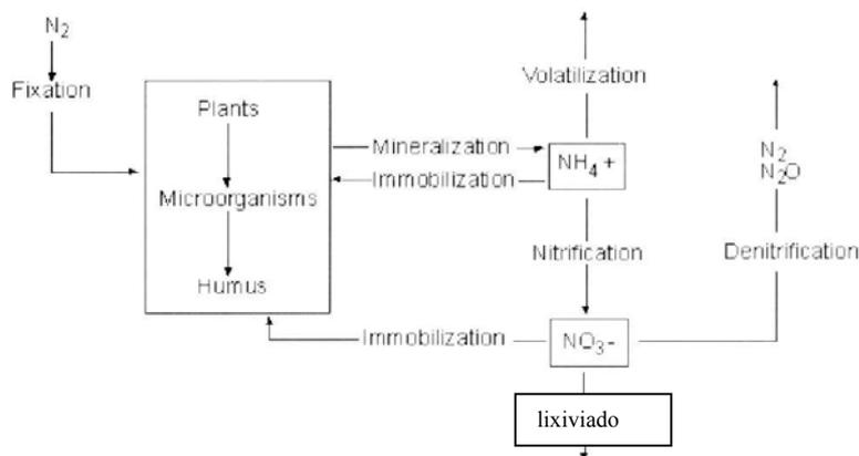
Figura 3: Ciclo generalizado del nitrógeno del suelo
