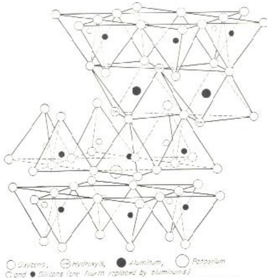
Figura 4 Estructura de la illita.
