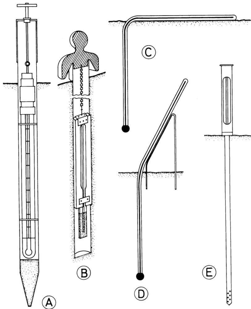
**Figura 14.** Modelos clásicos de geotermómetros (Instituto Nacional de Meteorología):
