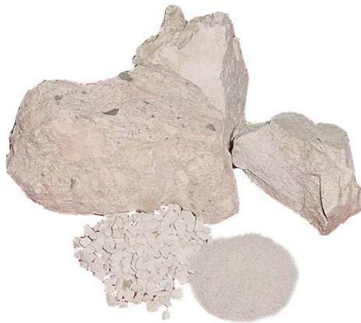
Foto 4. Zeolita, mineral y fracciones de diferente granometría
