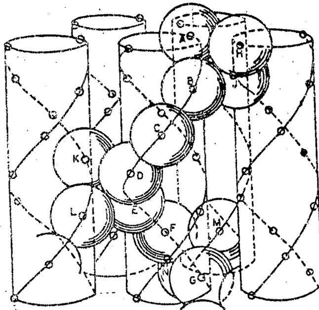
*Figura 12. Disposición helicoidal de los oxígenos en la estructura del cuarzo.*
