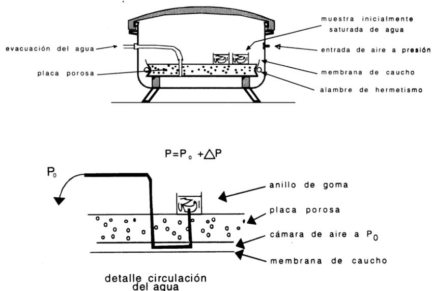
Figura 19. Placa de Richards. Esquema de funcionamiento.
