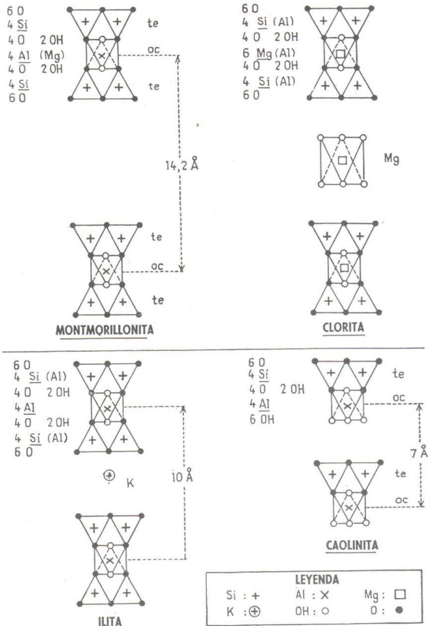
Figura 2. Esquema de los principales tipos de arcilla de los suelos.
