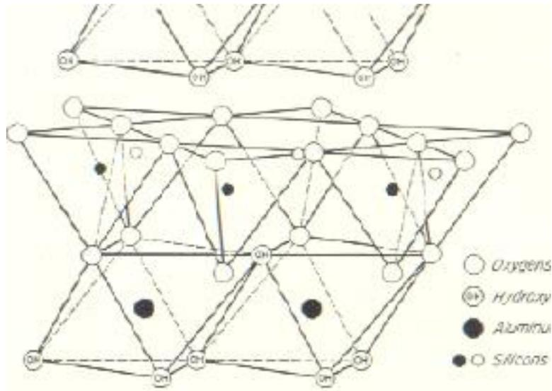
**Figura 3.** Estructura de la caolinita.
