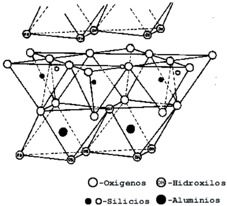
Figura 10. Disposición espacial de los átomos en un filosilicato.
