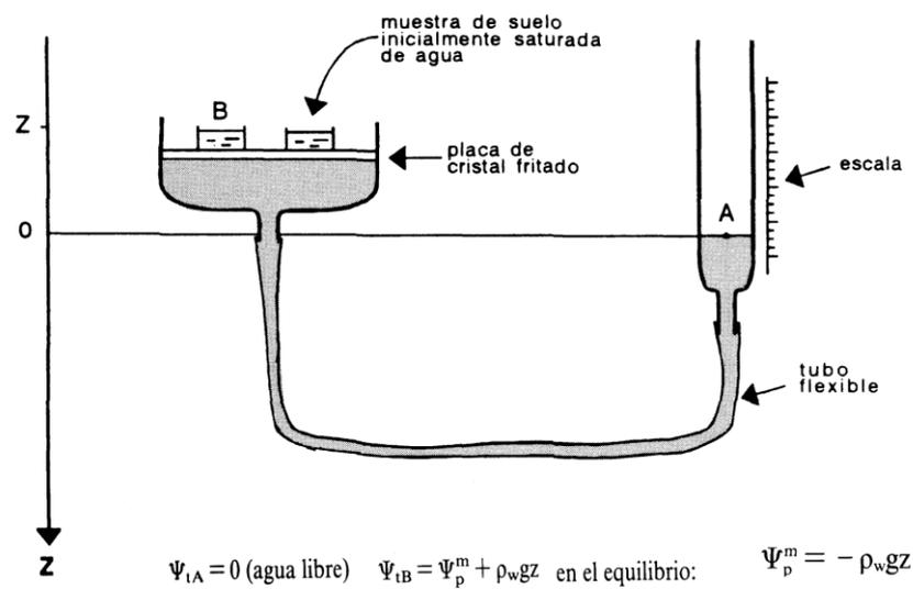
Figura 18. Placas de succión entre 0 a -100 kPa.
