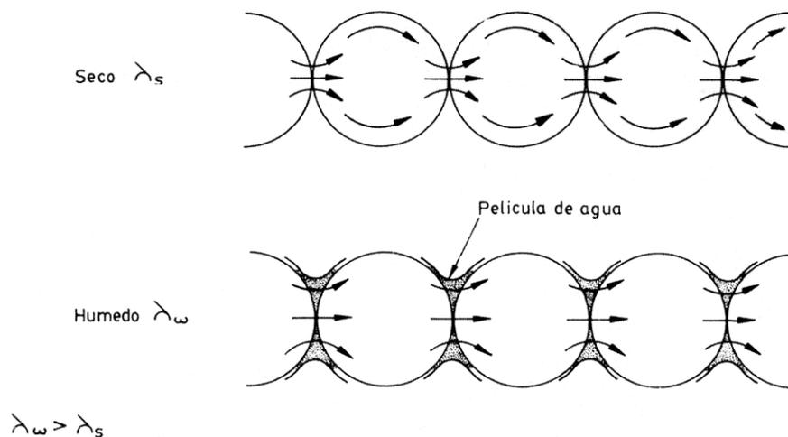
**Figura 13.** Conductividad térmica en suelos seco y húmedo.
